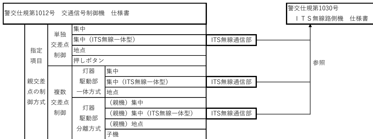
図 4.1 ITS無線一体型交通信号制御機の指定項目
