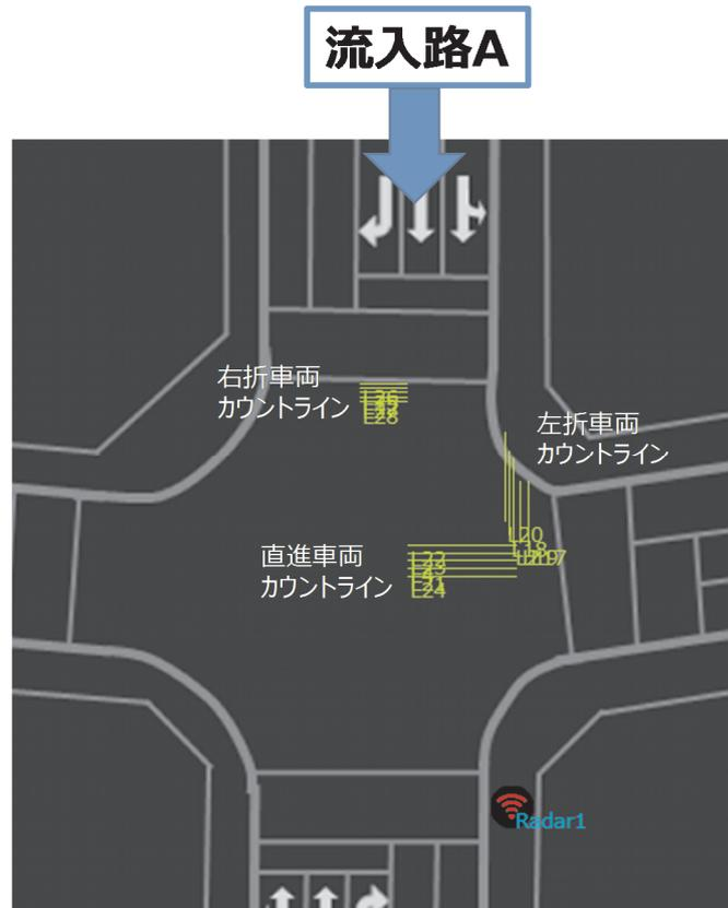
図 2.2.1-29 流入路 A の交通流カウンタのために設定した通過判断ライン群
