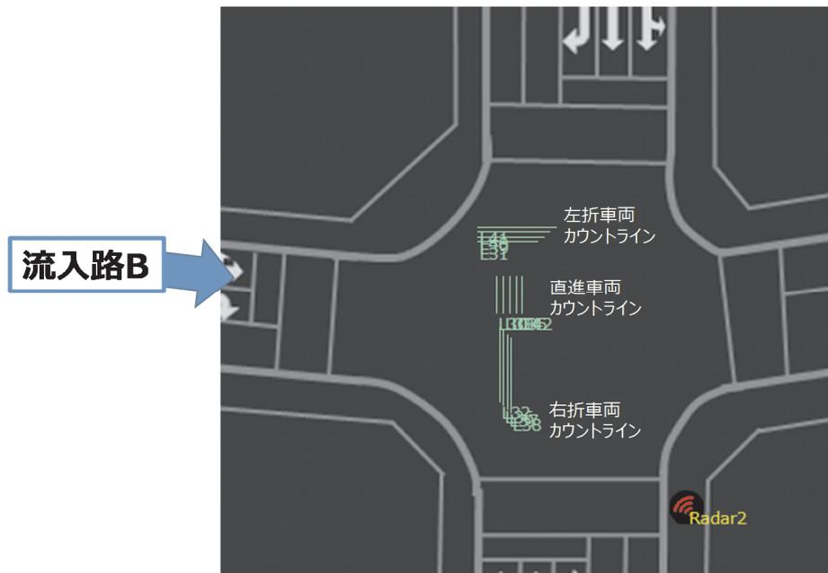
図 2.2.1-30 流入路 B の交通流カウンタのために設定した通過判断ライン群
