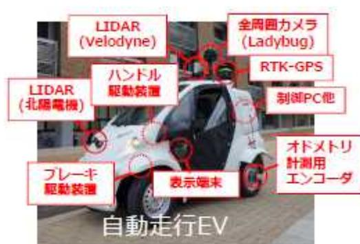
図 1-11 市販小型 EV 改造による自動走行車両に搭載する機能
