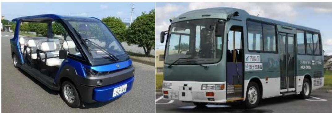
図 3-8 自動運転車両（左：ゴルフカート型、右：バス型
