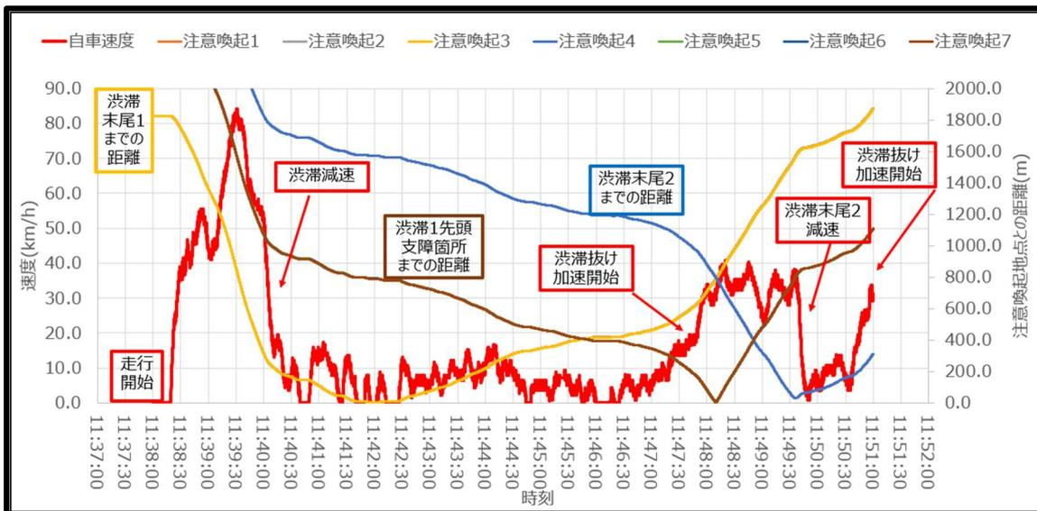
図 3-19 注意喚起情報受信時の自車両速度
