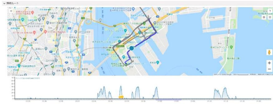
図 5-7 動態管理システムの Web システムにおける車両位置情報の表示
