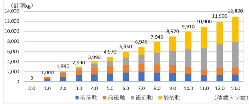
以上のとおり、13tのダミーウエイトの積載実験を5回行った結果、5回の全てで積載重量と軸重センサで計測された重量との誤差率は△1%程度で、5回実施の平均では誤差率△0.8%であった。また、同時に計測したマット式重量計による計測結果と軸重センサの計測結果とを比較した誤差率においても、5回の全てで△1%程度であり、5回実施の平均では△0.7%であった。
