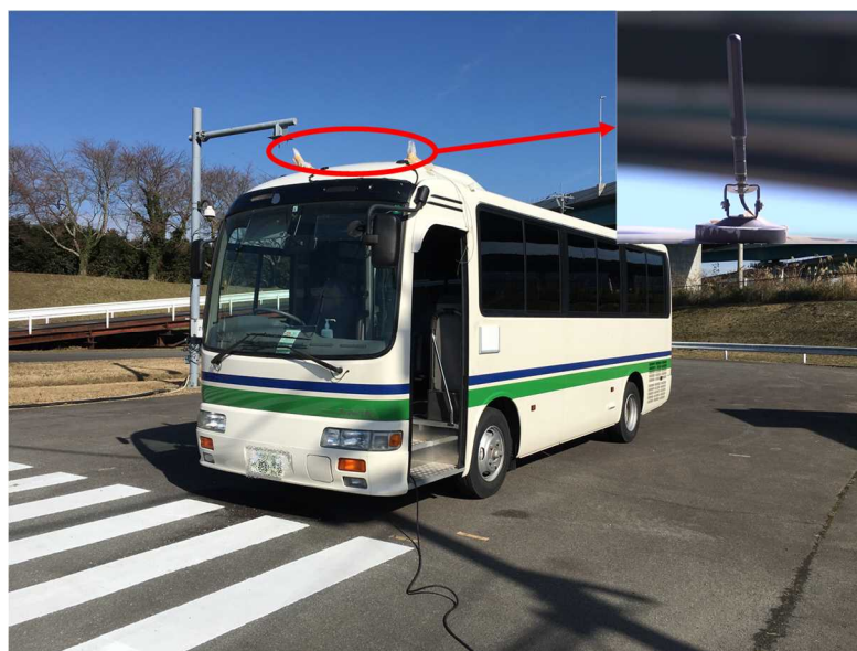
図 3.4.1-4 車載機を搭載した小型バス（赤丸に無線機アンテナを示す）
