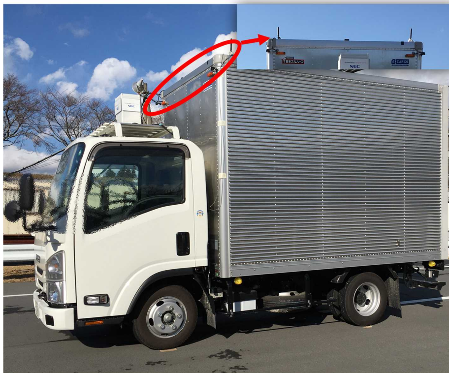
図 3.4.1-2 車載機を搭載した小型トラック（赤丸に無線機アンテナを示す）
