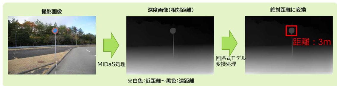
図 1-40 評価対象処理概要
