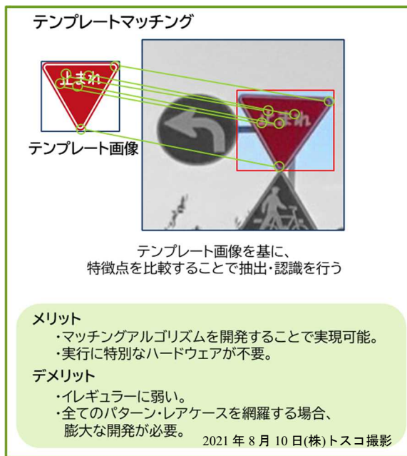
図 1-18 テンプレートマッチング概要
