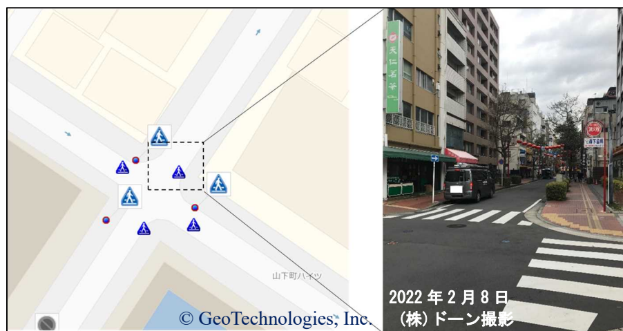
図 1-77 標識が設置されていない横断歩道の例
