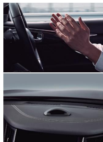
ドライバをモニタリングし、常に前方を注視しており直ちにハンドルを確実に操作できる状態で、同一車線内でハンズオフが可能
