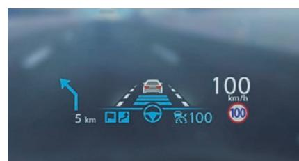
ナビゲーションと周囲の360度のセンシング情報に基づいて、ルート走行中の分岐や追い越しのための車線変更の適切なタイミングをシステムが判断し、ドライバーに提案。ドライバーがスイッチ操作で承認することで、車線変更支援を開始
