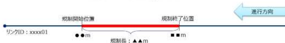
車線別の規制情報のデータ格納イメージ (正式にはHIDOより仕様開示を受けて下さい)
