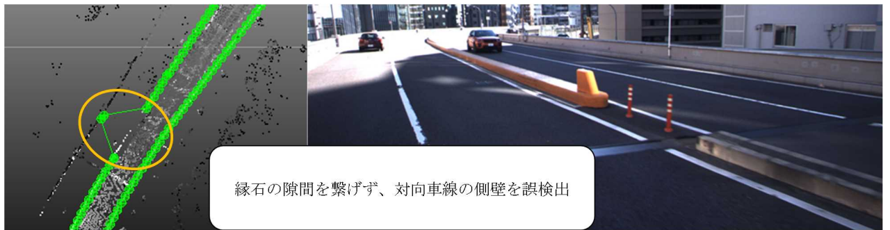
図 3.1-52 縁石の隙間による路肩縁の誤検出例
