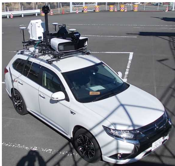
図 4.1-2 自動化技術を搭載したリアルタイム MMS 車両の外観（実験車両）
