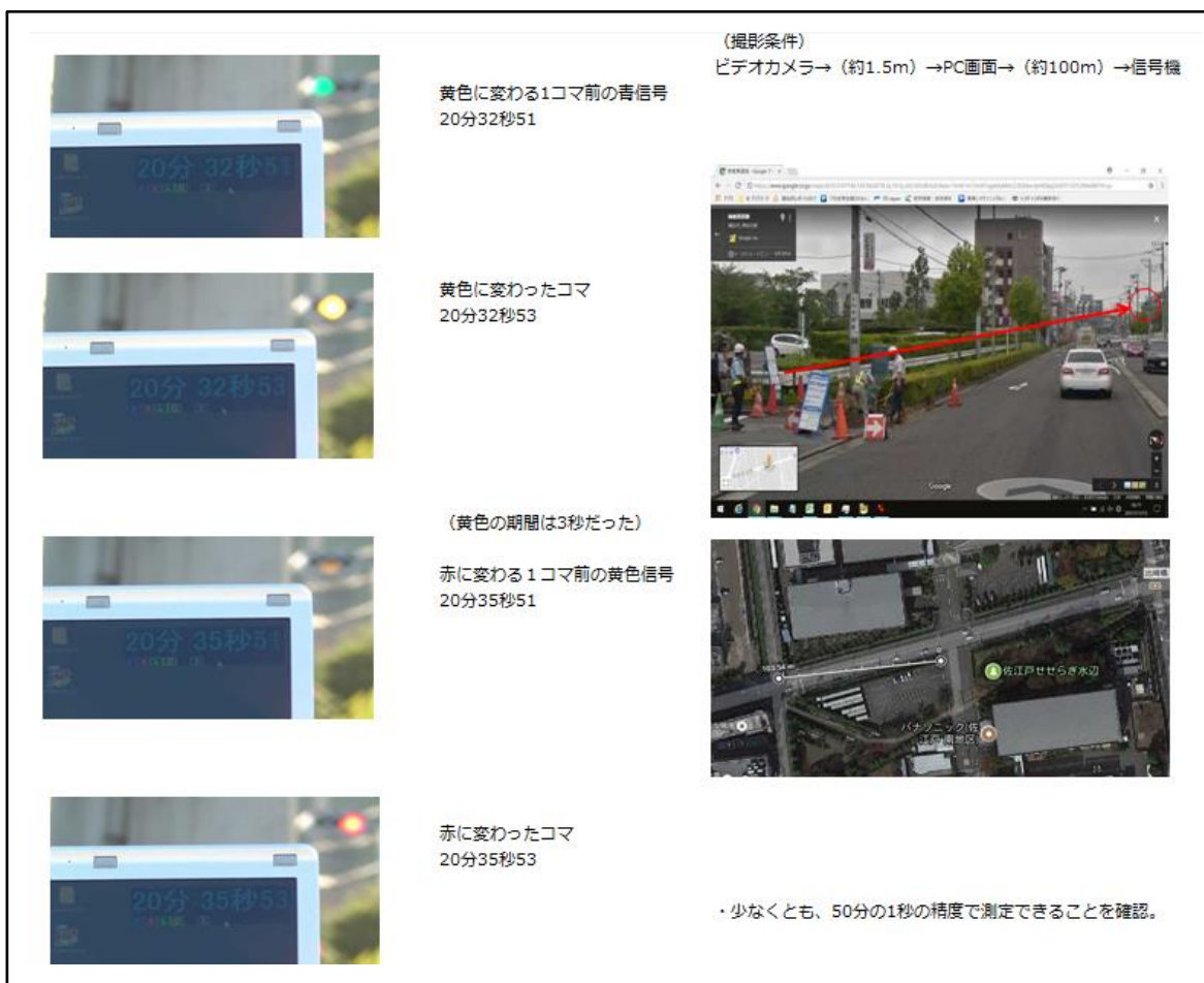
図 3.1.1-2 青信号の現示とシステム提供情報の差違時間の測定方法
