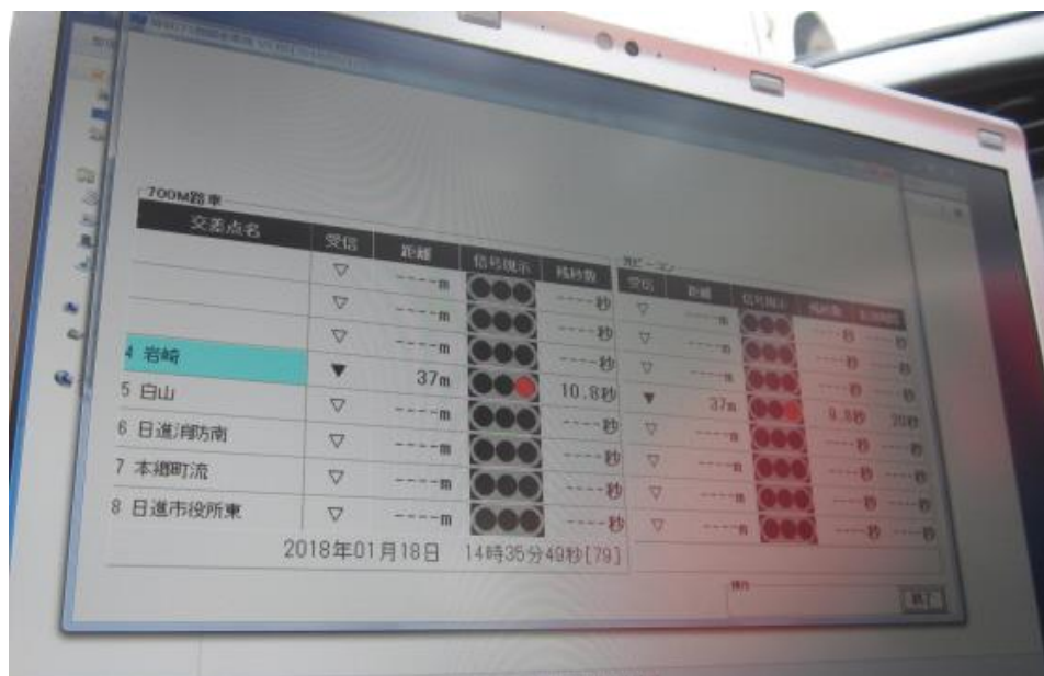
図 3.2.1 赤信号の提供時間 (ITS 無線路側機及び光ビーコンでそれぞれ 10.8 秒と 9.8 秒の例)
