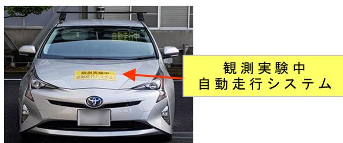
図 5-68：外向け HMI（メッセージ掲示型）の設置位置
