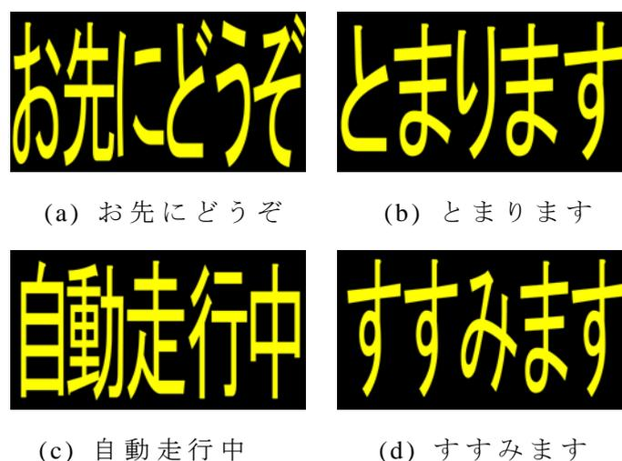
図 5-10：実験で使用したメッセージ表示型外向け HMI のコンテンツ
