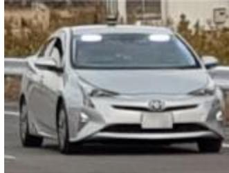
図 5-75：外向き HMI (LED 点滅光) の設置位置
