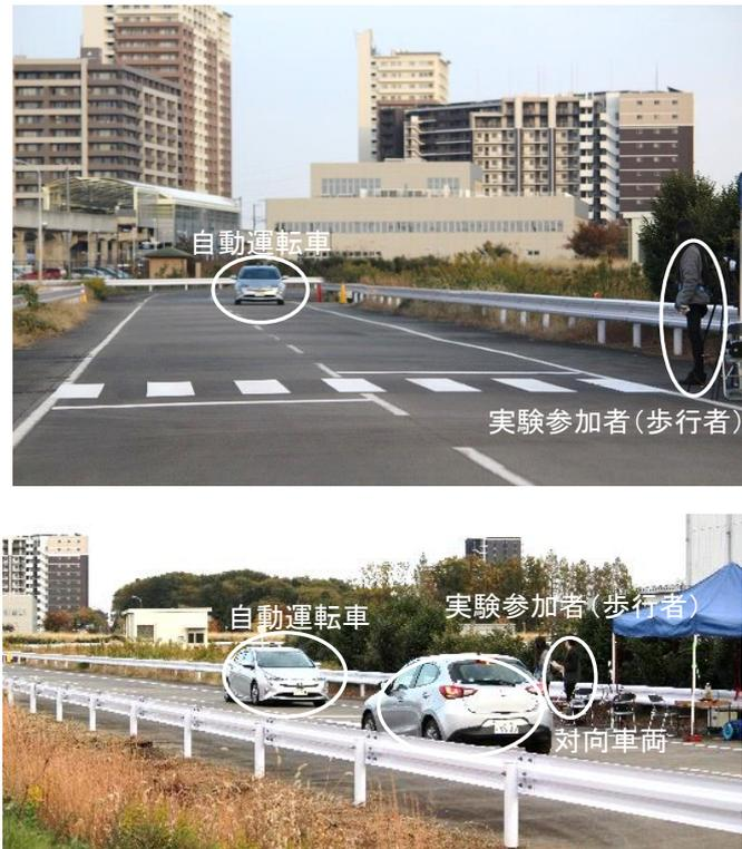
図 5-44：交差点部で自動運転車の接近・進入と歩行者、対向車両の状況
