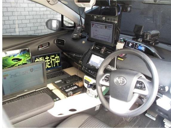
図 5-2 : 実験車両車室内の制御や計測・記録のための PC 類
