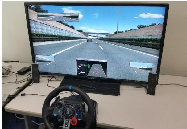
図 3-27 実験 A-3-1 使用ドライビングシミュレータ
