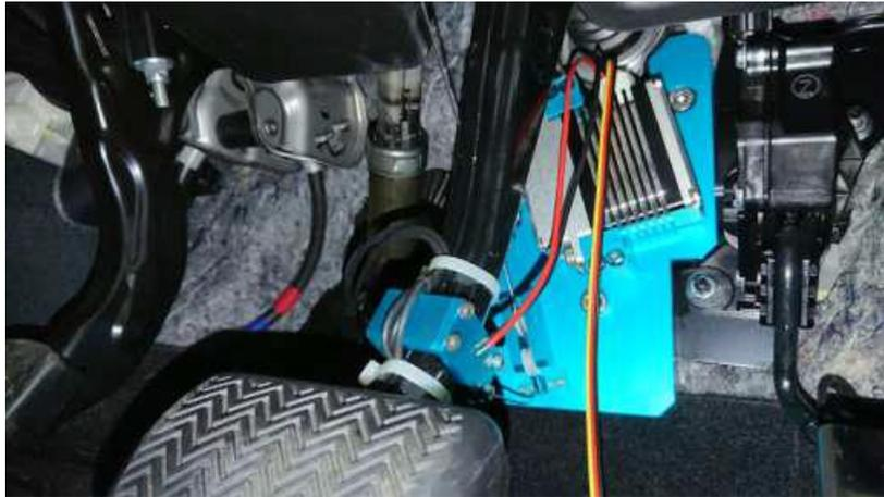
図 5-3 : 実験車両搭載の速度制御装置およびブレーキ制御アクチュエータ
