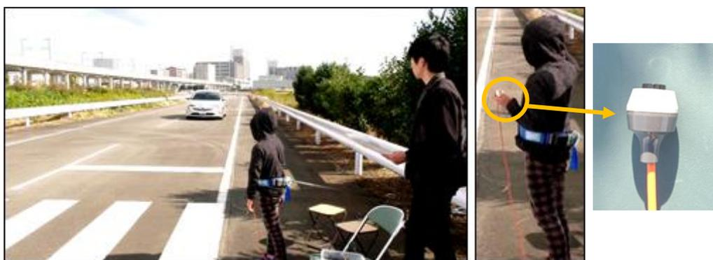
図 5-38：実験被験者付近の反応スイッチと安全ベルト
