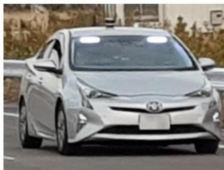
図 5-5 : 灯火型外向き HMI の設置位置
