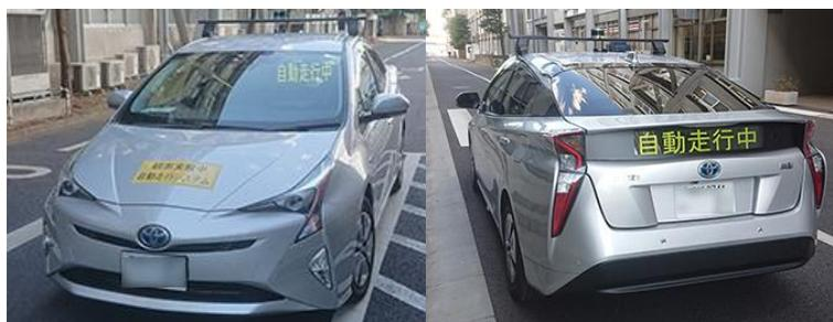
図 5-73：外向き HMI（液晶ディスプレイ）の設置位置
