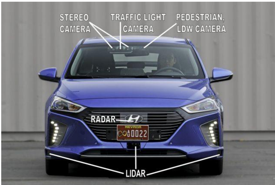
図 5-17 Hyundai IONIQ に搭載されるカメラ ( https://www.extremetech.com/extreme/241242-hyundai-ioniq-self-drive-car-flawless-right-turns-no-danger-speeding-tickets より出典)
