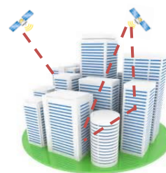
a) トンネル等の GNSS 不感地帯 b) GNSS 測位精度が低下する高層ビル街等
