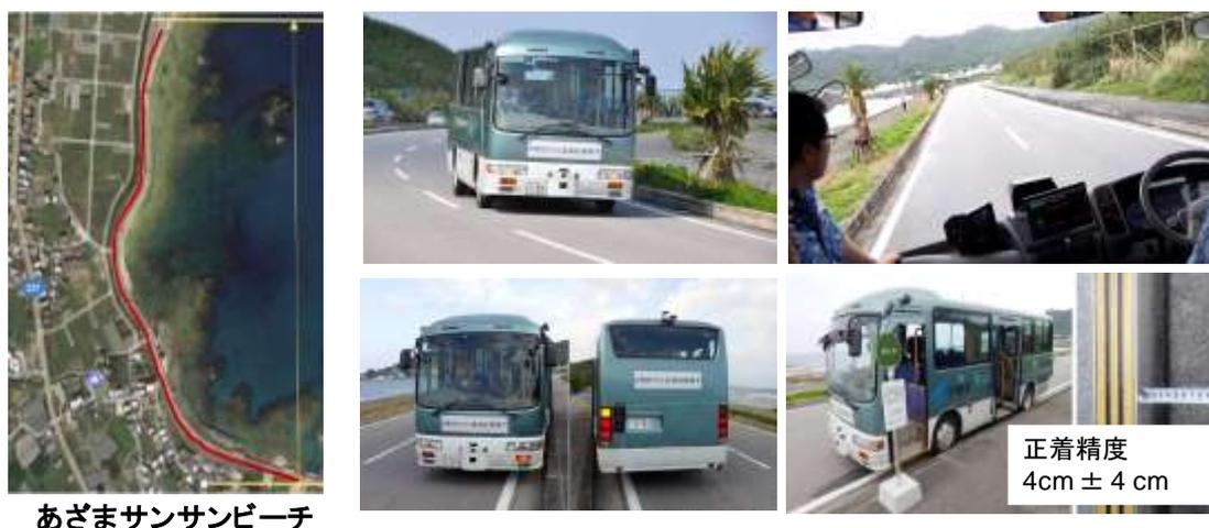
図 4.1.1-1 バス停への正着制御の実証実験
