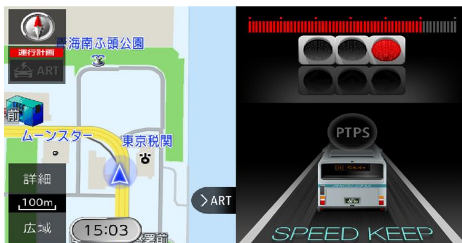
図 3-11 速度維持でちょうど青信号に変わり通過できる場合の表示図
