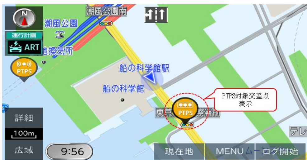
図 3-32 路車間情報による流入路 A での PTPS 対象交差点表示
