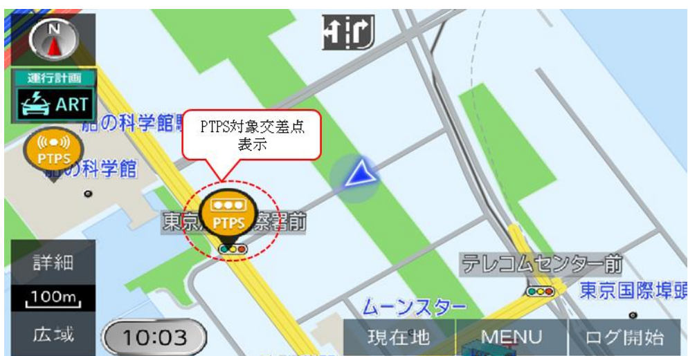
図 3-33 路車間情報による流入路 B での PTPS 対象交差点表示
