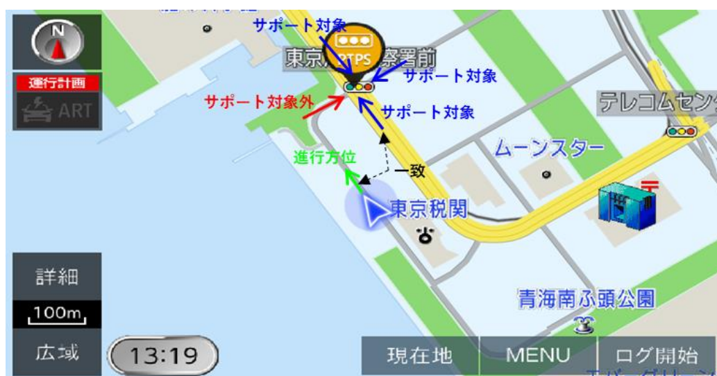
図 3-39 サポート対象外方路で PTPS 対象交差点アイコン誤表示例
