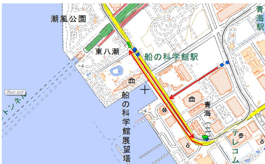
図 3.2.1-3 ITS無線路側機から車載機への通信範囲（バス）
