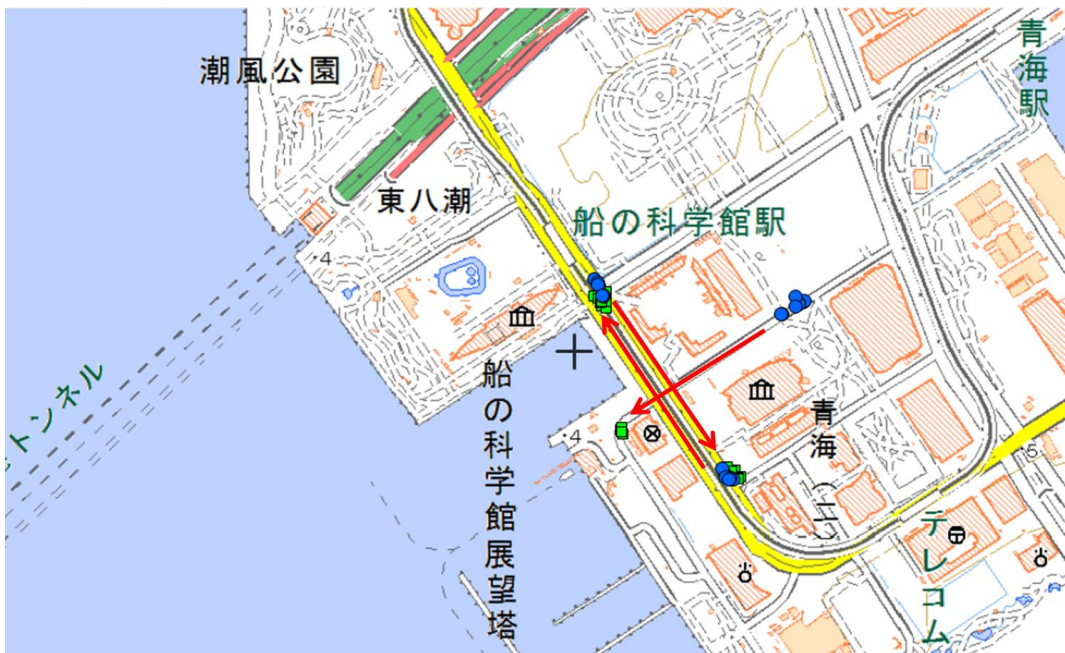
地理院地図（電子国土 Web）に●：連続通信開始位置、■：連続通信終了位置を付加。 図 3.2.1-2 I T S 無線路側機から車載機への通信範囲（小型トラック）
