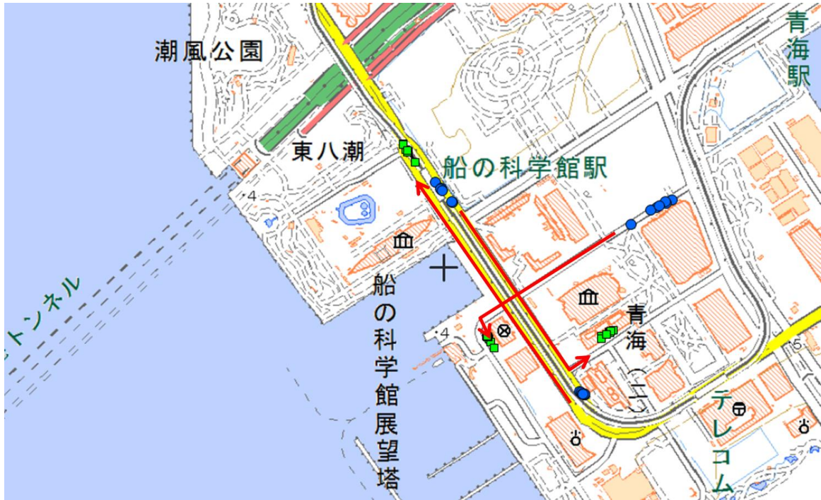
地理院地図（電子国土 Web）に●：連続通信開始位置、■：連続通信終了位置を付加。 図 3.2.1-1 I T S 無線路側機から車載機への通信範囲（乗用車）
