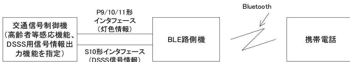
図 3.19 DSSS 信号情報を使用した方式の機器構成
