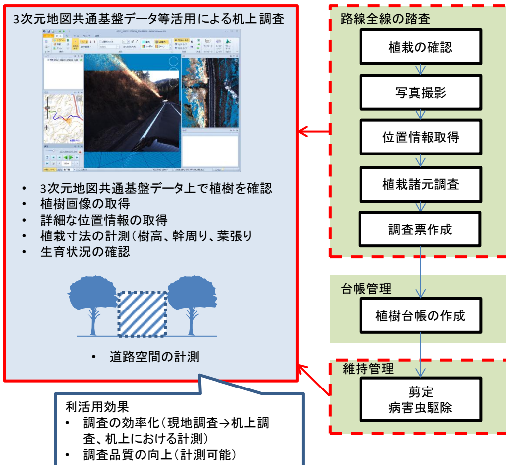
図 2-12 3 次元地図共通基盤データ等を活用した街路樹調査フロー
