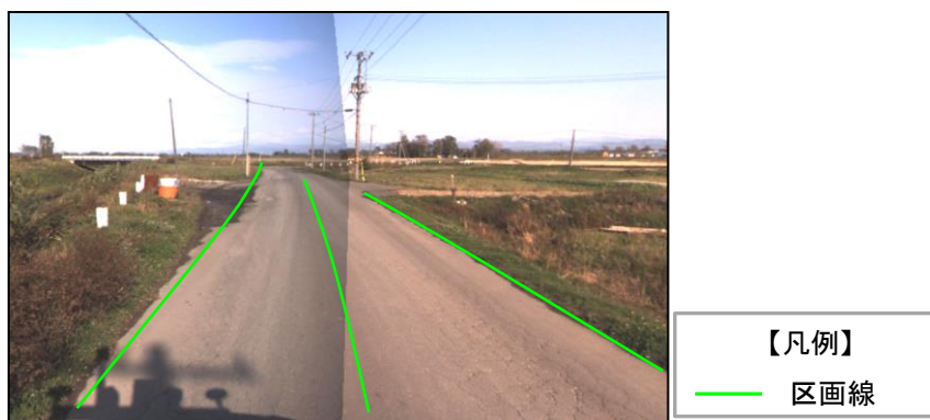
図 3-79 区画線の図化（舗装路）の例
