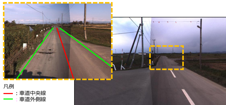
図 仮想の車道外側線、車道中央線の作成例
