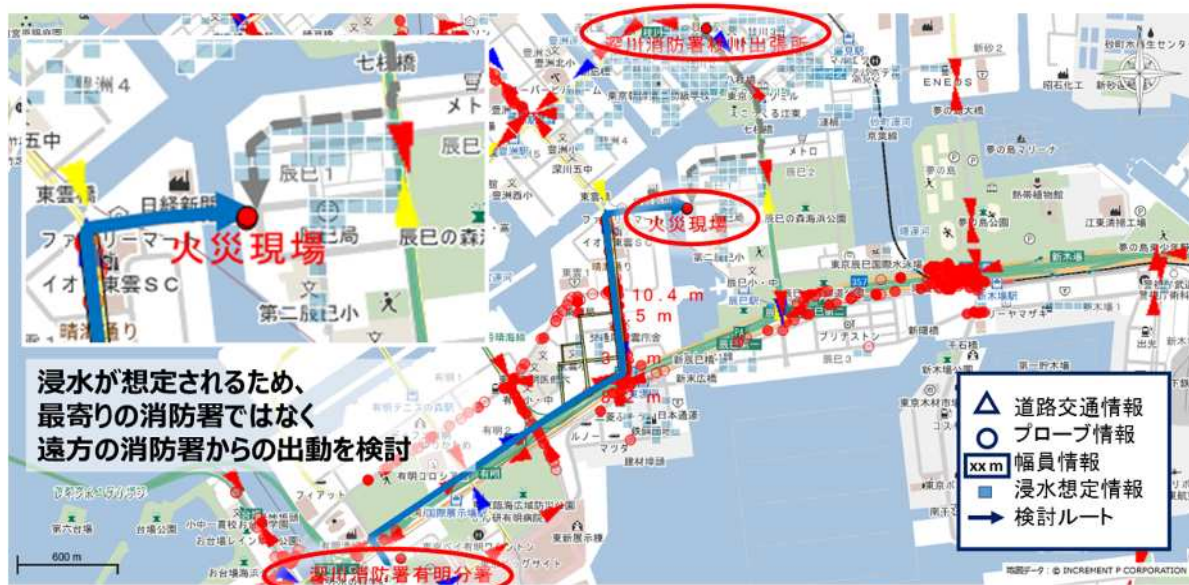
図 4.2.1-5 気象 / 浸水想定情報を活用したルート案内支援システム画面
