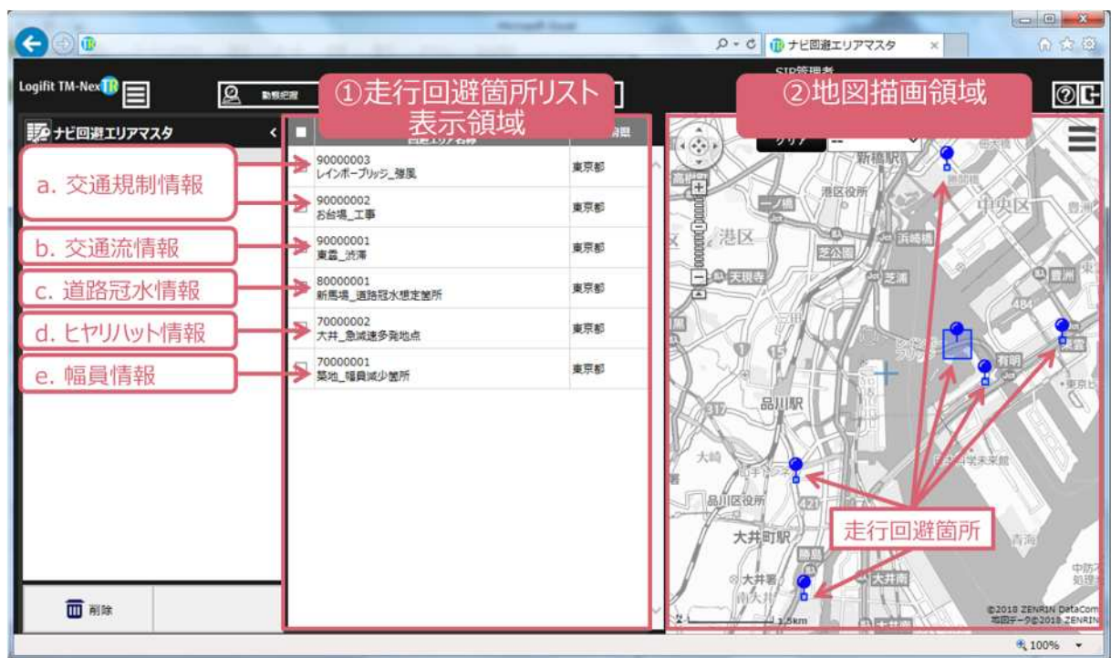
図 4.1.1-2 運行管理システムの走行回避箇所表示画面
