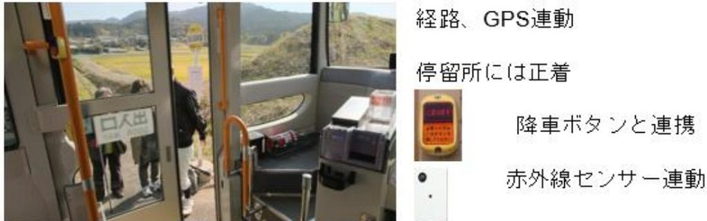
図 2.2.3-8 ドアの自動開閉
