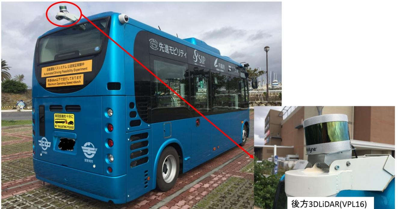
図 2.1.2.4-4 後方センサの搭載様子
