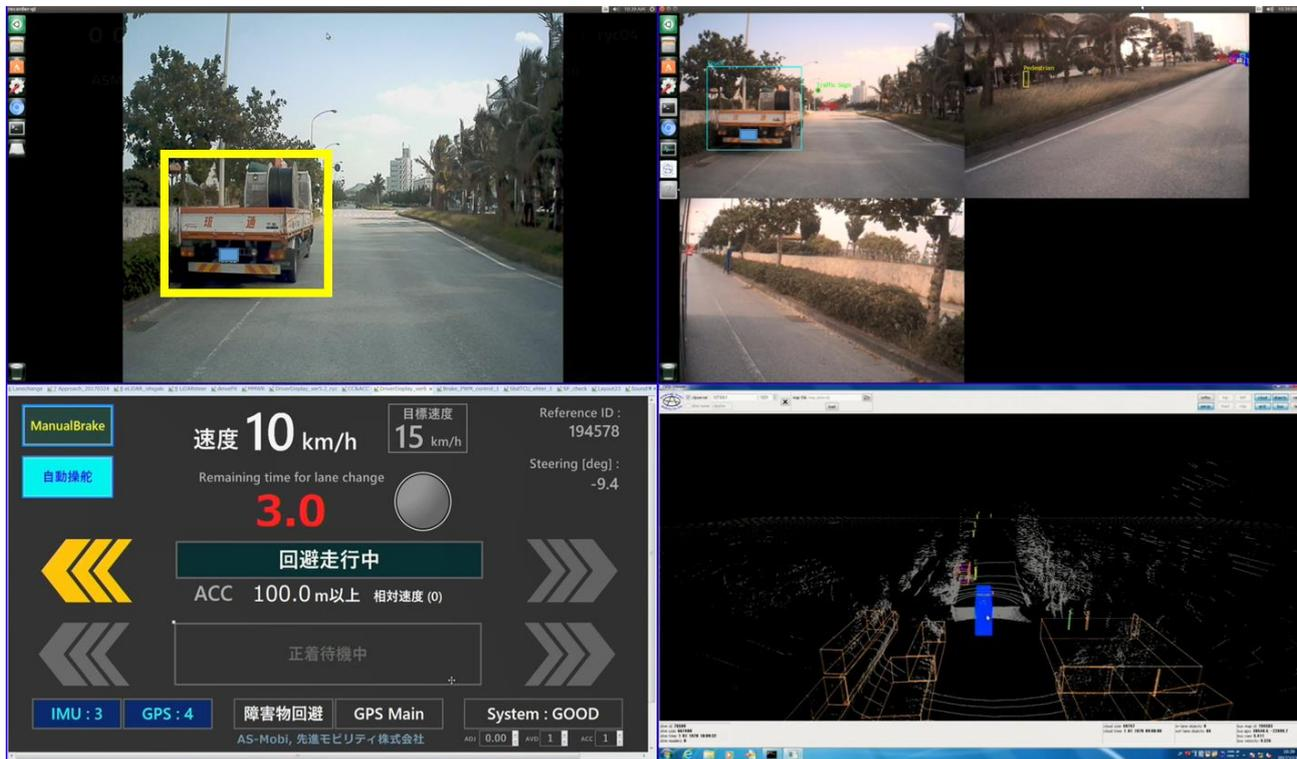
図 3.3.3-2 車線維持制御のオーバーライド例(路肩の大型車両)
