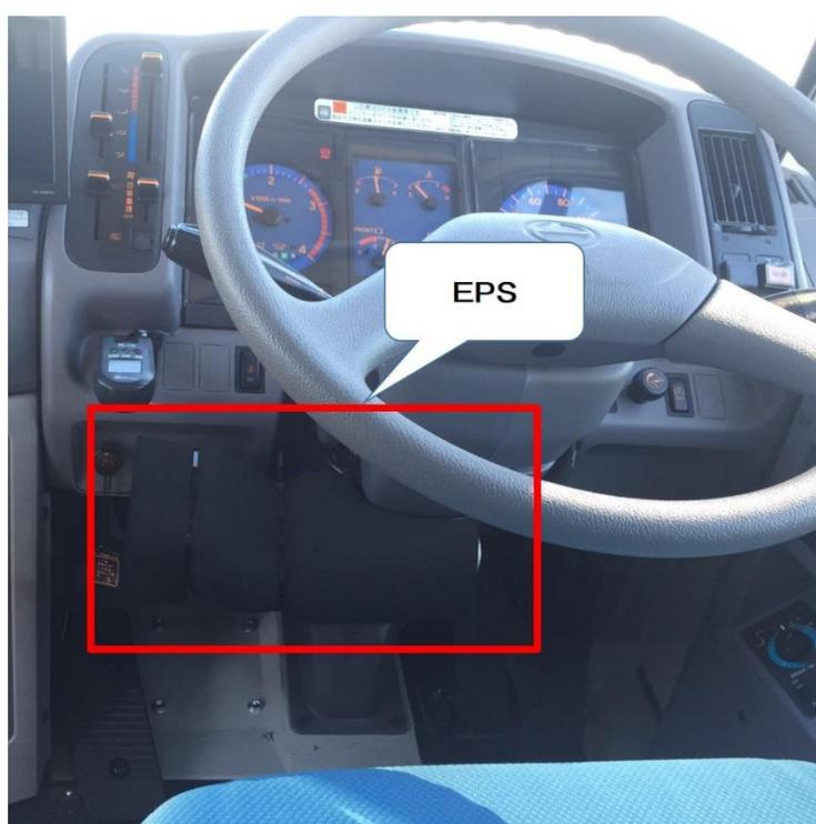
図 2.1.2.1-1 電動パワーステアリング (EPS)
