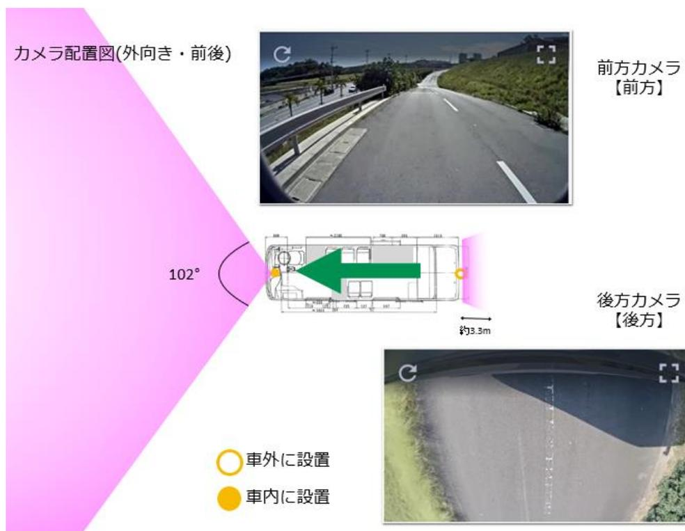
図 2.2.3-2 前方、後方カメラの映像
