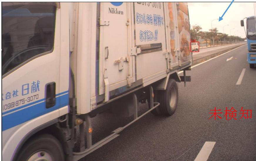
図 3.3.6.1-4：後側方カメラの評価におけるパターン 2 の未検知例
