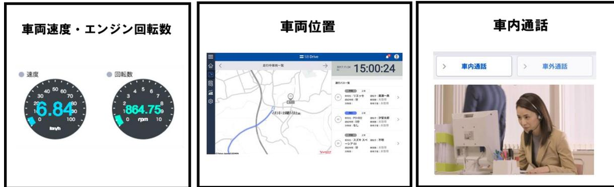
位置や速度を遠隔から監視することで、車両が正しく走行しているかどうかを遠隔監視者に伝える。状況に異常が発生した時点で遠隔監視者が車両映像を確認し、車内乗客とのコミュニケーションが必要な場合は遠隔監視者が車内通話機能を使うことで双方向通話を行った。
