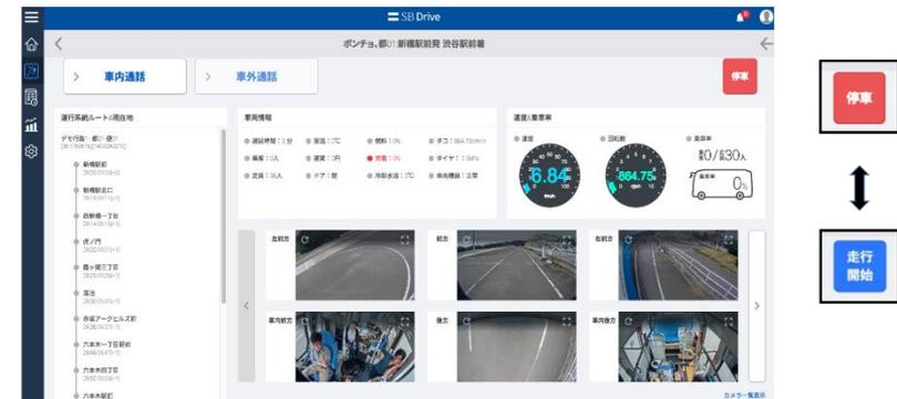
画面右上のボタンが走行中は「停止」、停止時は「走行開始」へと変化し、遠隔から車両の停止及び走行開始を行うことができる。
