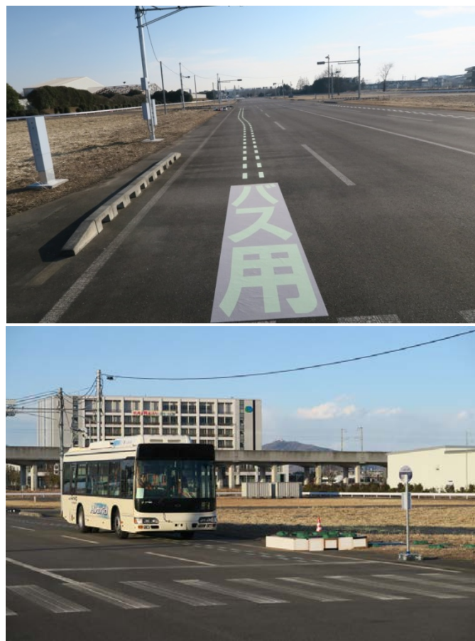
図 3-8 検証に用いた誘導線③と正着検証用のバス停設置状況
