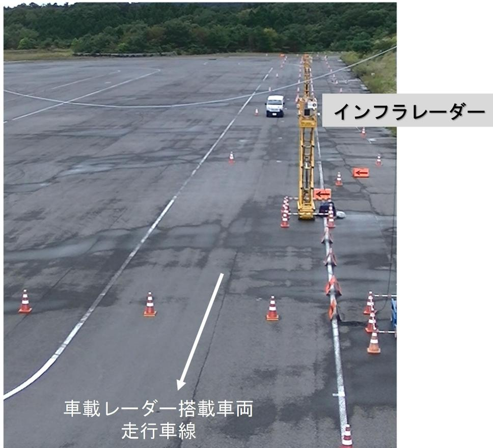
図 4.1.2.1-6 高速道路合流部を想定したテストコースの全景
