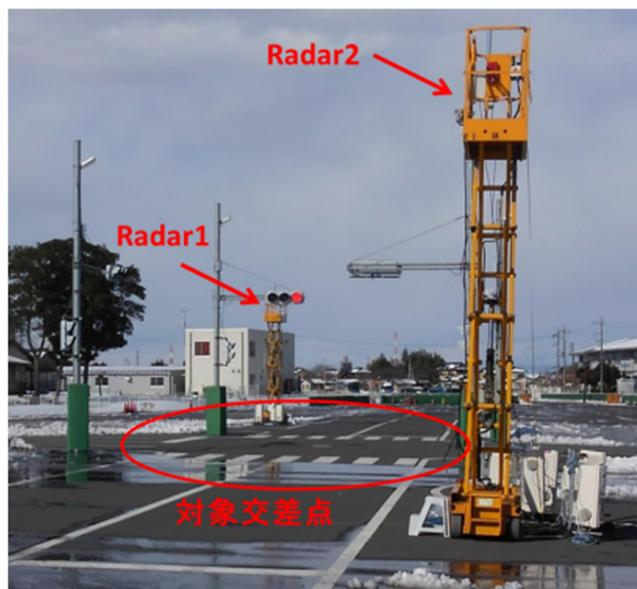
図 4.3.3.2-13 統合クラスタリング実験時のレーダー設置状況
