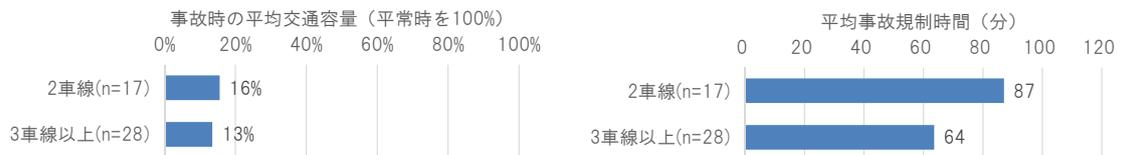
図 4-9 事故時の平均交通容量および事故規制時間（車線数）
