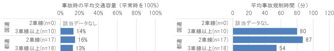
図 4-13 事故時の平均交通容量および事故規制時間（道路種別×車線数）
