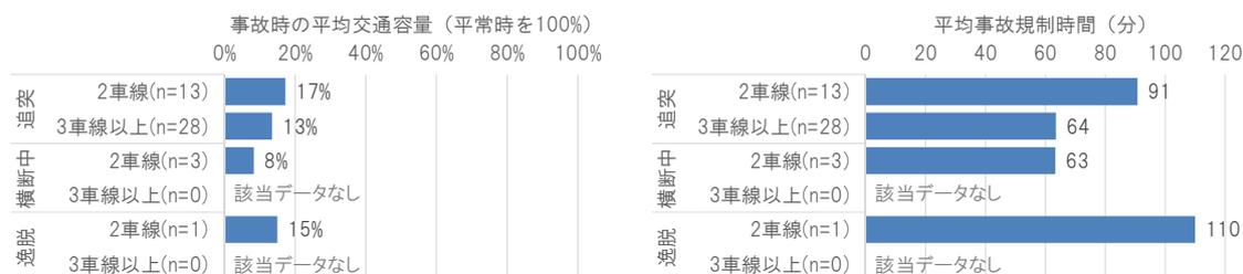
図 4-12 事故時の平均交通容量および事故規制時間（事故類型×車線数）
