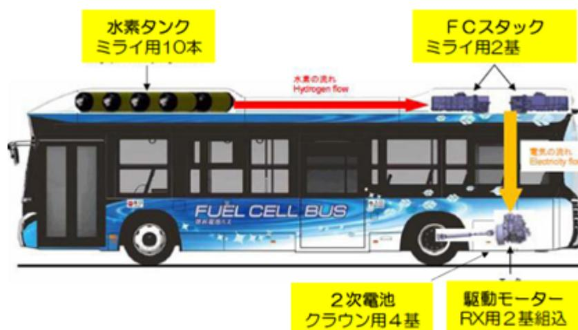
図 3-6 燃料電池バスの外観<sup>9</sup>
