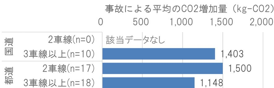
図 4-21 事故時の CO<sub>2</sub> 排出量増分（道路種別×車線数）
