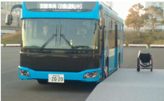
カメラやLidarを用いたセンサフュージョンによる自動正着制御に加えて、操舵系の機械的なあそびを操舵角進み制御によって補正
