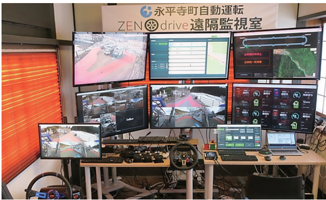
図2 永平寺町での遠隔監視システム
