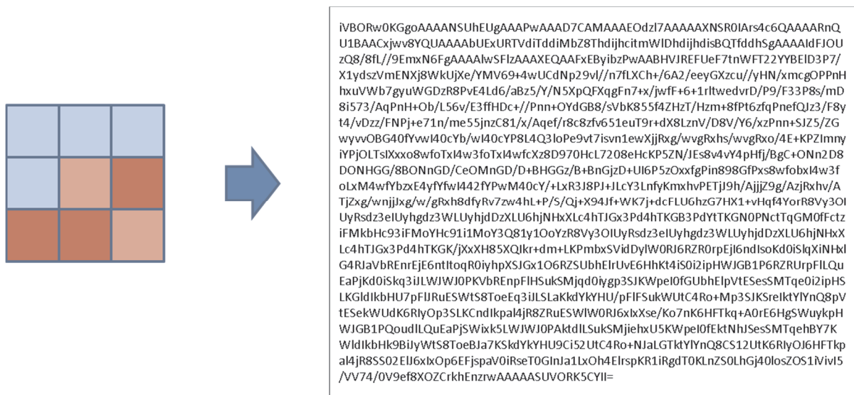
図 3.2.2-1 BASE64 符号化によるバイナリデータの埋め込みの例
