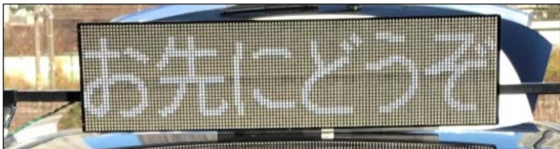
図 5-29 テキスト表示型外向け HMI の外観
