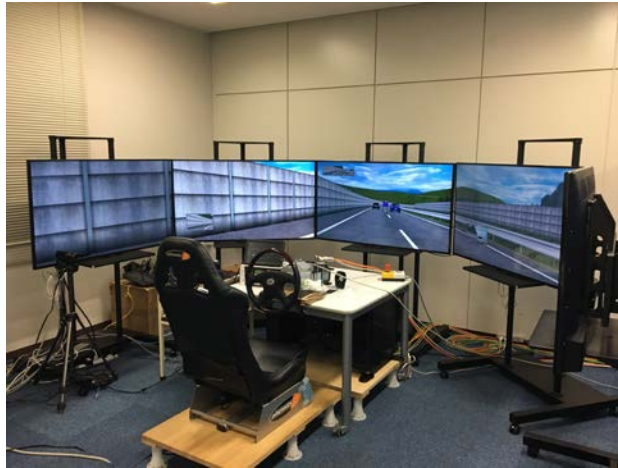
図 3-50 実験 A-8-2 使用ドライビングシミュレータ
