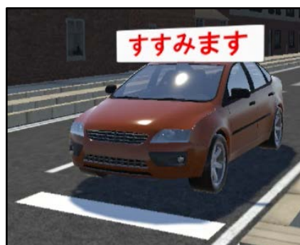
図 5-54 ダミー条件における外向け HMI (すすみます)
