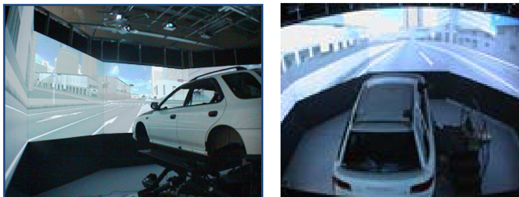
図 5-86 シミュレータ実験で使用したドライビングシミュレータの外観
