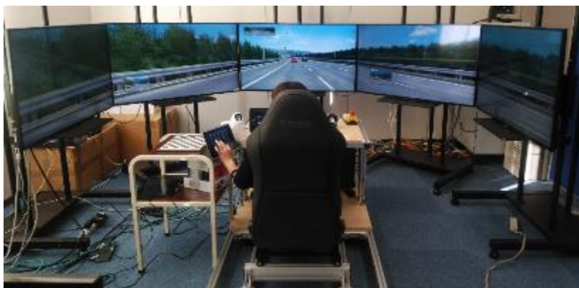
図 3-13 実験 A-6 後半実験で使ったドライビングシミュレータ
