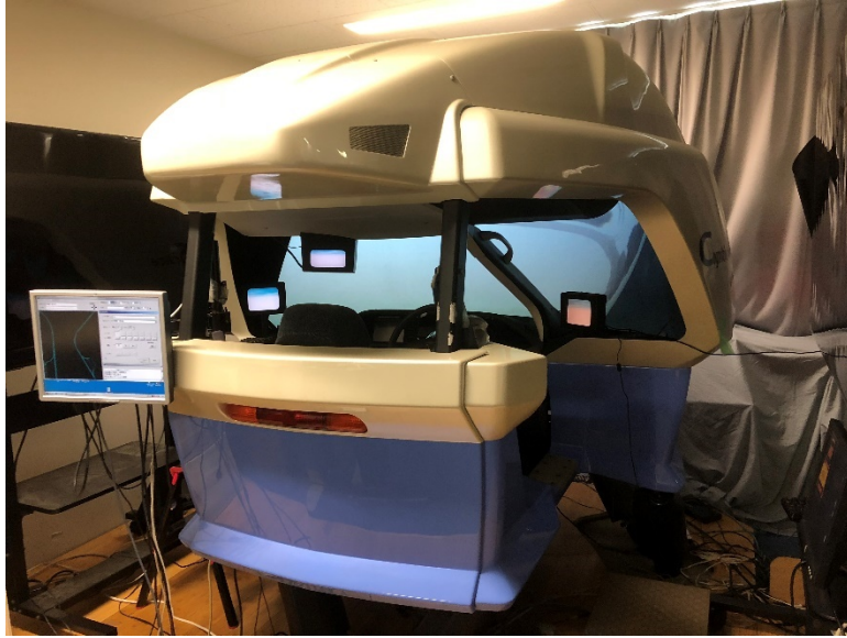
図 3-16 ドライビングシミュレータ外観
