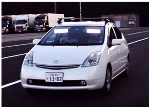
図 5-10 灯火型外向き HMI の外観
