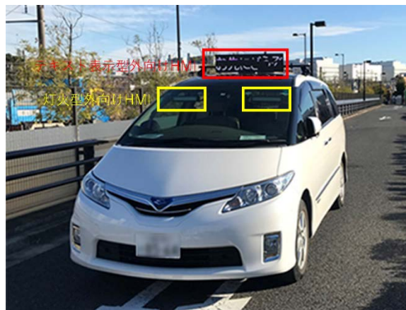
図 5-26 自動運転車役の実験車両と装備された外向け HMI (赤枠：テキスト表示型、黄枠：灯火型)
