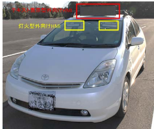
図 5-6 自動運転車役の実験車両と装備された外向け HMI (赤枠：テキスト表示型、黄枠：灯火型)
