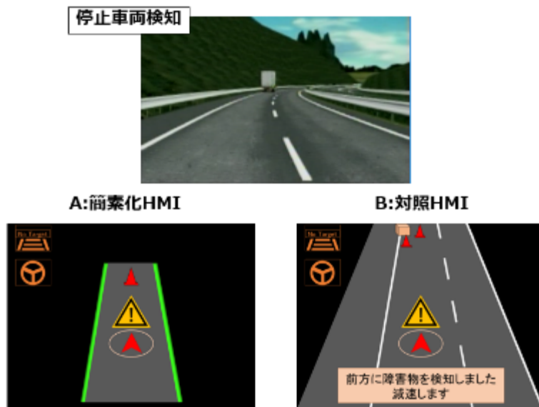
図 3-30 停止車両検知時の各 HMI の表示
