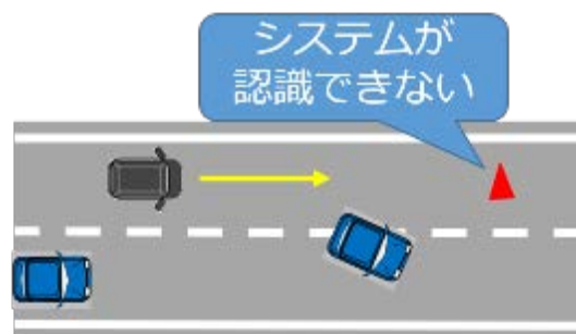
図 3-33 障害物不検知（交通量が多い場合）
