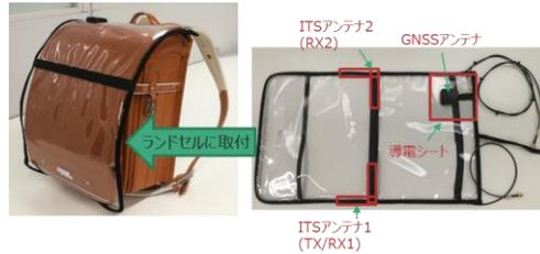
ITS通信距離と測位精度について、リュックサックと同等以上の性能を確認
