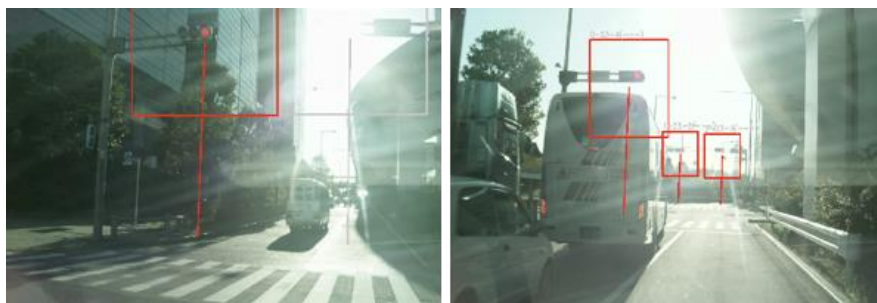
(a) 昼間の逆光時のシーン（左：右信号が太陽と重なり視認不可）
