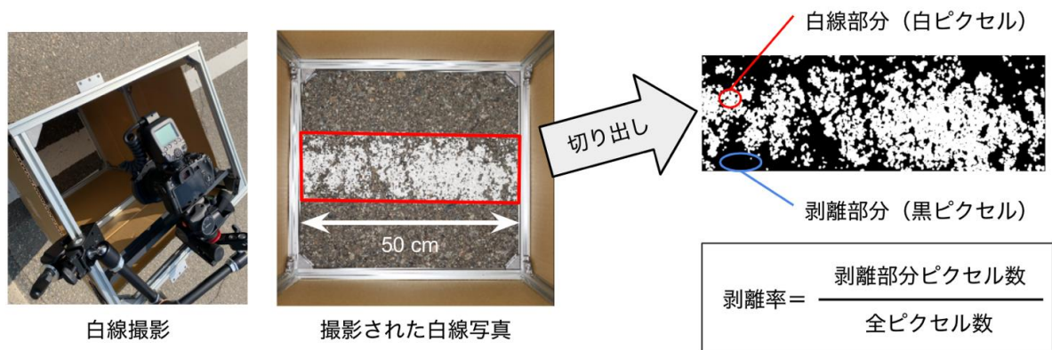
図 2.3.③-8 白線の剥離率を計測する処理の流れ
