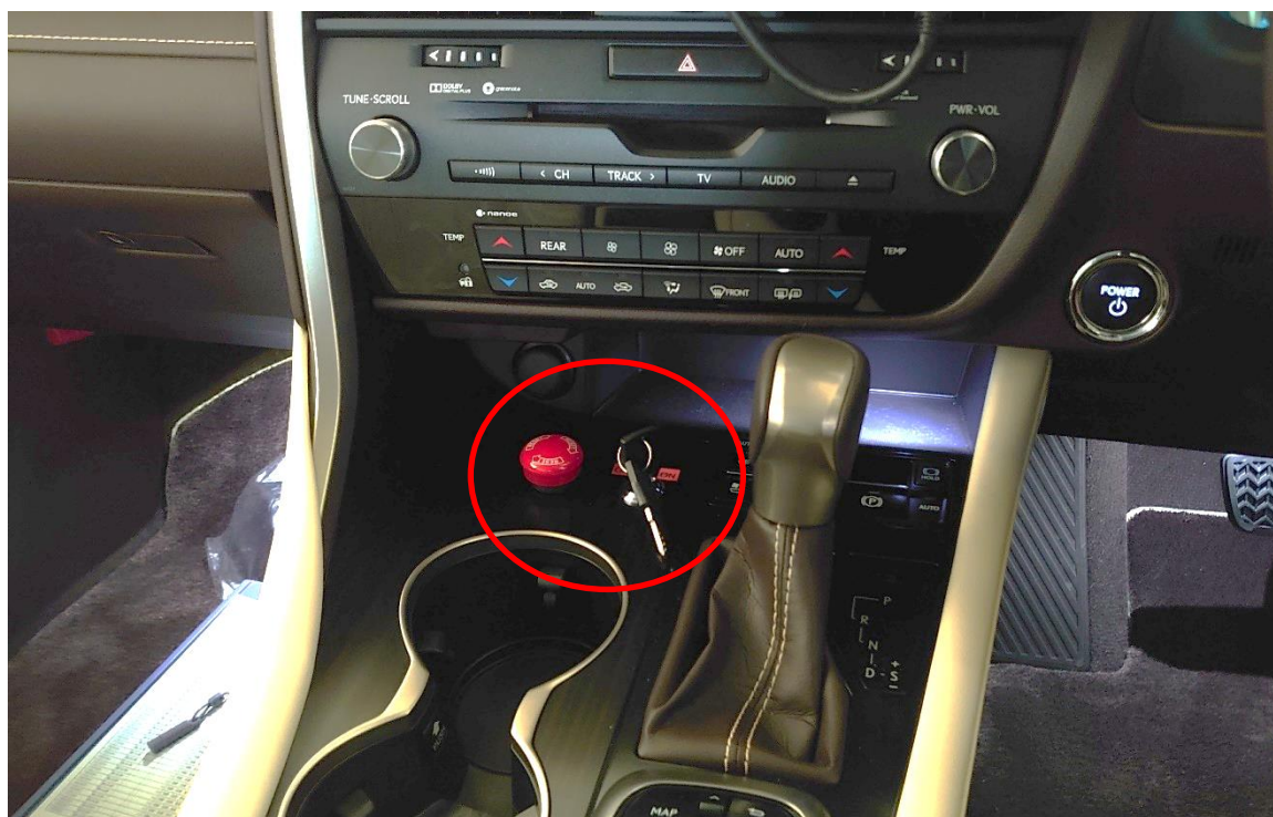
図 2.6-1 試験車両内に設置した手動運転・自動運転切り替えスイッチ
