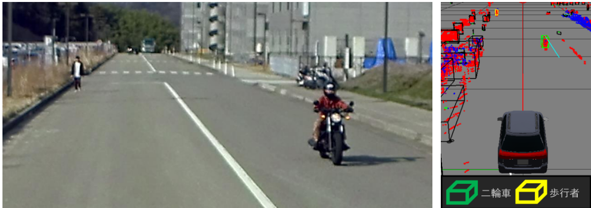
(a) バイクと歩行者が接近するシーンの認識結果
