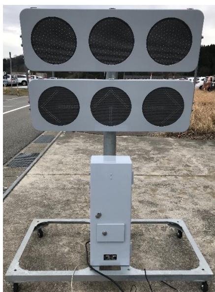
(a) LED 式仮設交通信号機
