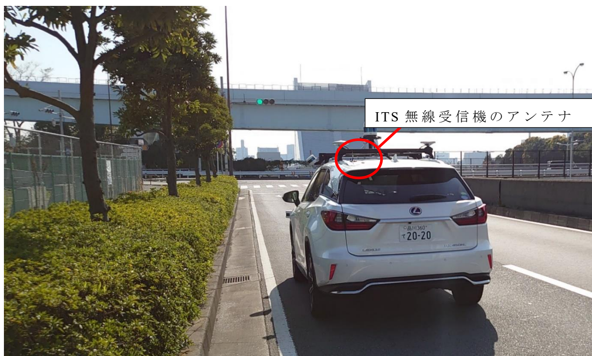
図 2.6-5 試験車両に搭載した ITS 無線受信機を用いて ITS 無線路側器と通信を行っている様子
