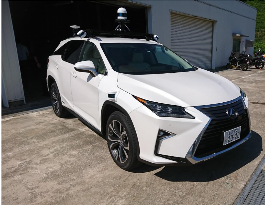
図 2.6-2 センサ搭載済みの試験車両内の外観
