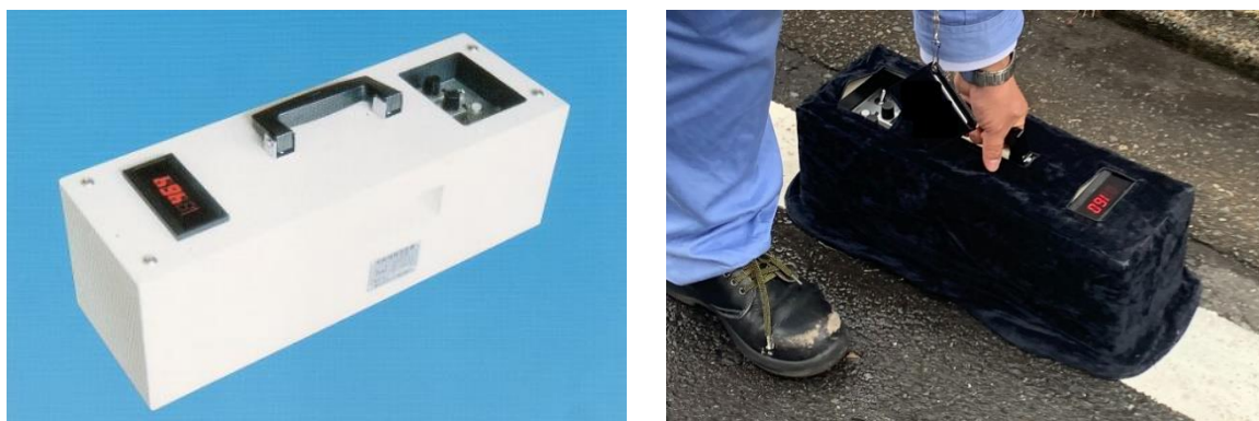
図 2.3.③-2 手動計測器（ミロラックス 7）の外観および反射輝度値の測定の様子
