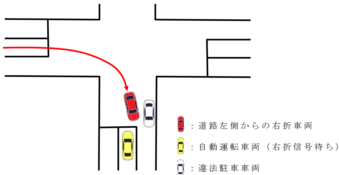
図 2.5.①-2 実際に遭遇したデッドロックが発生しそうな状況
