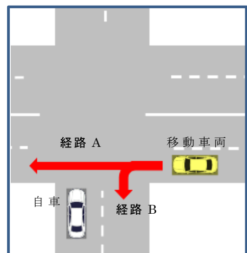
図 2.4.②-9 交差点で移動車両経路の判断
