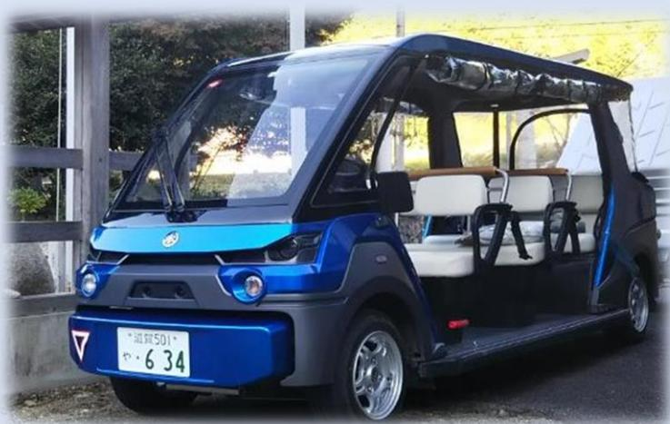
走行方法: 埋設された電磁誘導線からの磁力を感知して、既定ルートを走行
