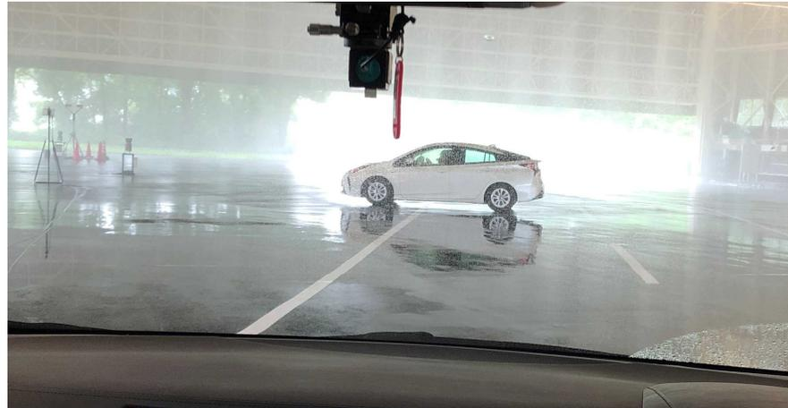
■ 20m先のプリウスを撮影、路面に車両が投影されている
