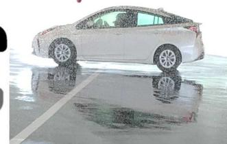
⑤ 濡れた路面での鏡面反射による虚像(偽点)の発生
