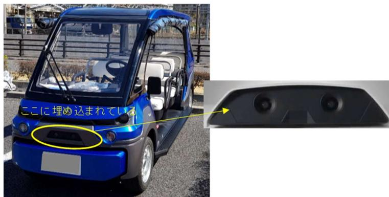
図 3-58 緊急停止のための装置 (effi-vision)
