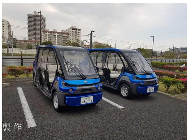
図 3-50 実験車両（ゴルフカートタイプ）の外観
