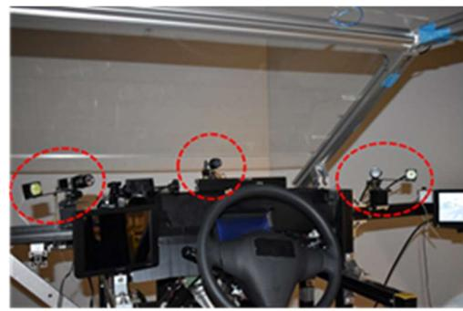
図 4-5 視線計測システム
