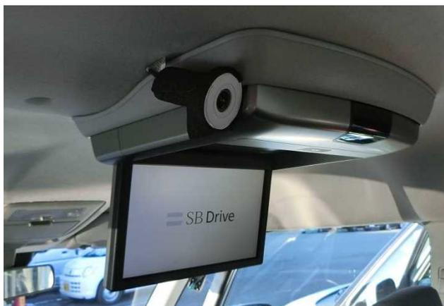
図4 車両に設置された車内カメラ
