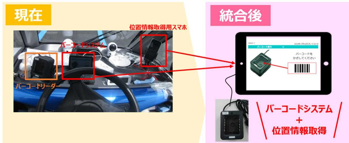
図 8-2 車載器のパッケージ化のイメージ
