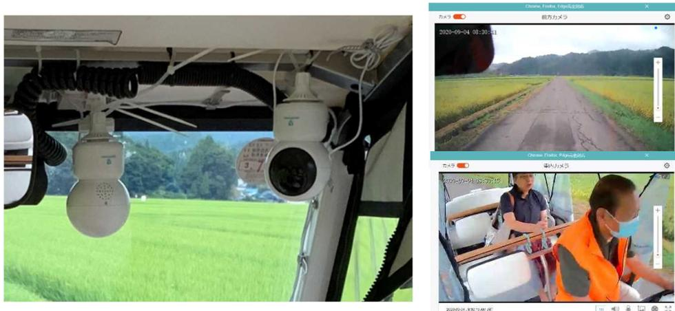
図 6-5 運行監視システム（セキュリティカメラ）と前方・車内画像
