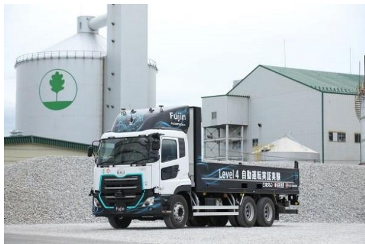
図表 1.3-5 5Gの車両間通信を活用したトラック隊列走行実証実験
