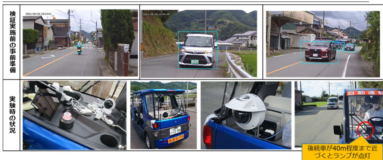
図 3.24 AI カメラの設置状況と後続車検知の様子
