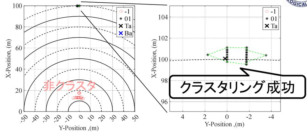
距離50mでのパラメータに固定 ( $\epsilon = 1.4 \text{ m}, \text{Minpts} = 9$ )
