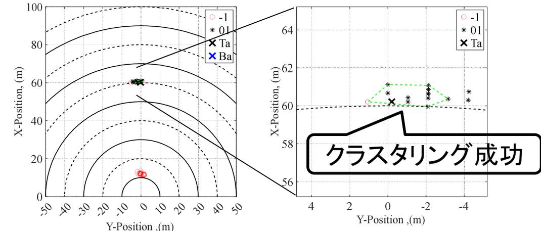
距離20mでのパラメータに固定 ( $\epsilon = 0.6 \text{ m}, \text{Minpts} = 13$ )
