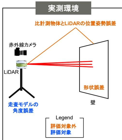
平面にビームを投影させて赤外線カメラで解像度を計測する。
