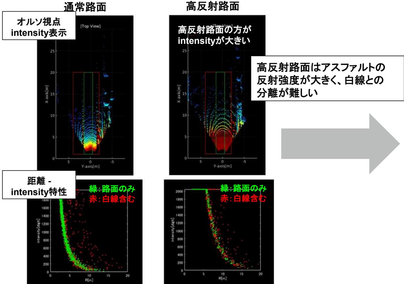
積算路面点群の「距離 - intensity特性」
