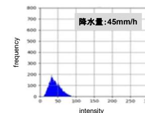
降雨不調の再現には、雨粒の反射に起因して生じる“偽点”の現象把握、LiDAR出力への影響把握が必須
