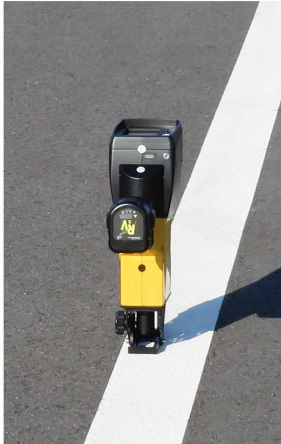
モバイル再帰反射計測器
