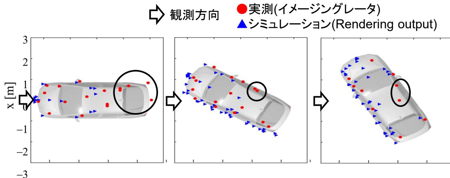
受信信号レベルが距離に対して変動し、最大ピークレベルの誤差は5dB以下であることを確認したピークの発生距離・強度の一致性に対し、受信強度の落ち込みの深さの差異が課題である
