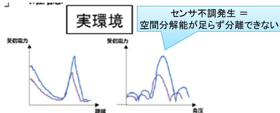
対策案1: 車載センサでは無く、高分解能の計測器を使用
