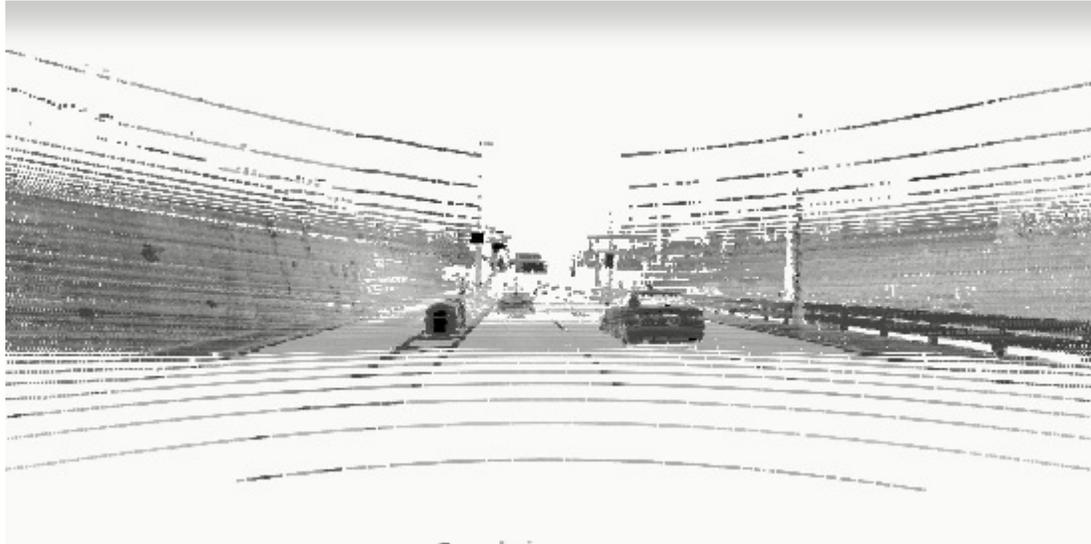
図.2Dグレースケール画像(黒:反射高, 白:反射低)
