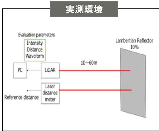
■ LiDARとLambertian反射体の距離を変えて計測する。
