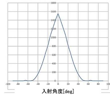
正対時の反射率が①より②の方が**2.3倍**強くなる反射モデルである。
