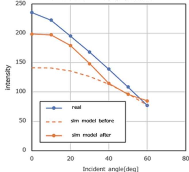
改定した反射モデルでは実測の指向性を有する反射特性を再現できた
