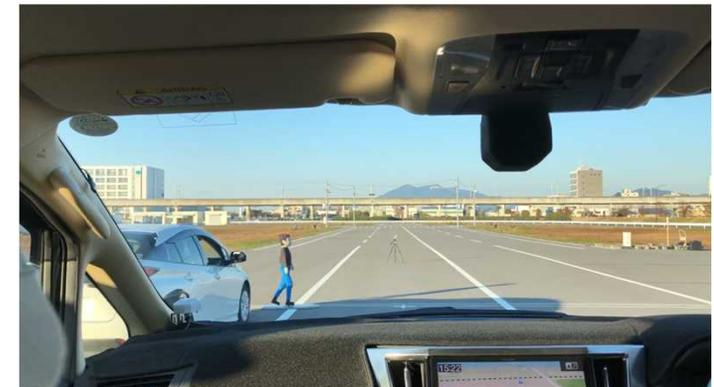
大型車両に対するセンサ知覚、認識性能評価に向けたサーベイ実験を開始。
