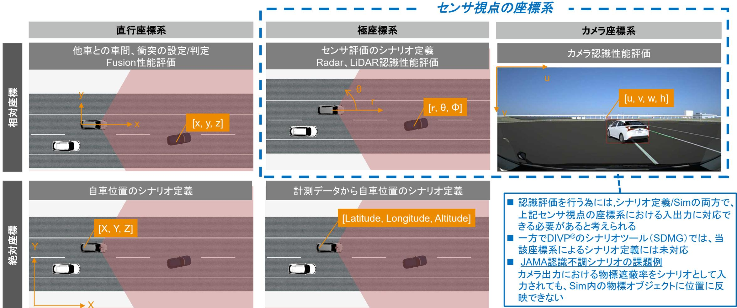
それぞれの座標は相互変換が可能 ただし、カメラ座標系はレンズスペックに依存するため実機相当のレンズモデルの場合は計測・計算誤差が大きく乗る場合がある
