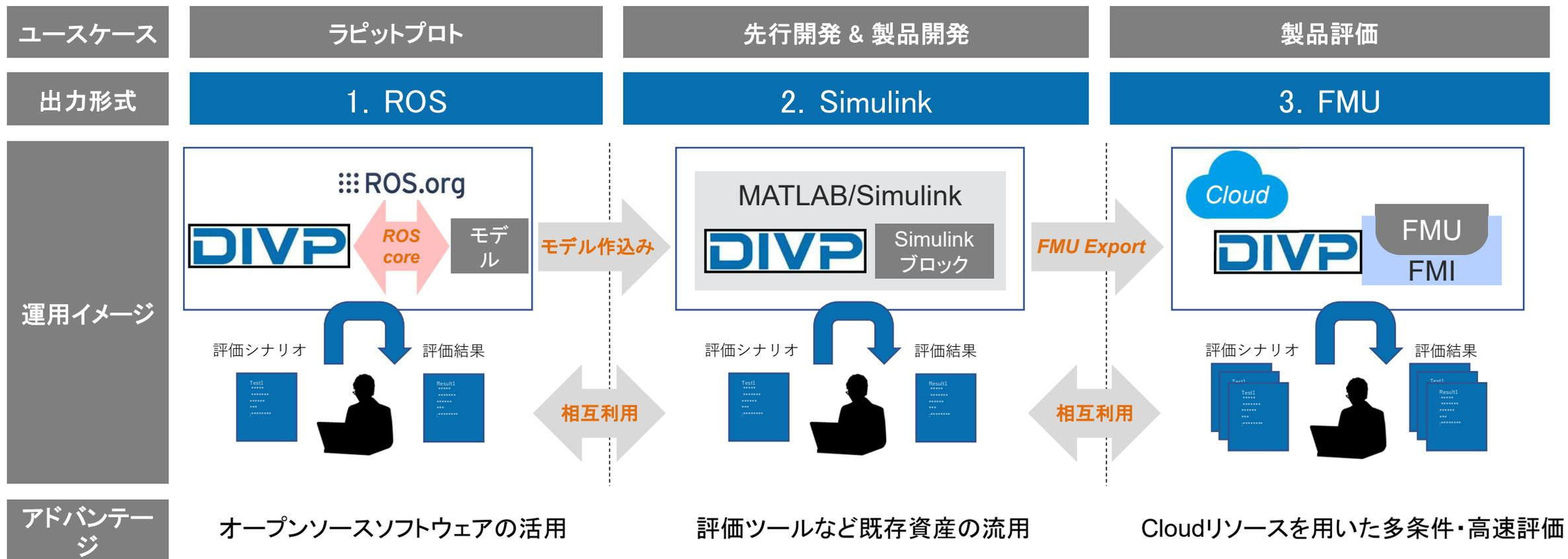
ROS-mod、Simulinkモデル、FMUモデルの各モデルとDIVP®を接続し、SIM評価が出来ることを確認
