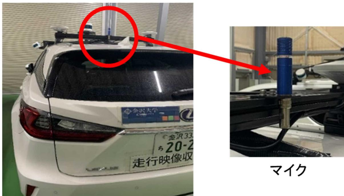
図 2.6-3 試験車両に搭載した環境音計測用マイク
