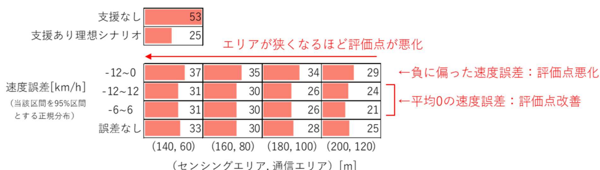
図 51. 余裕のない合流となった車両台数（センシングエリア／通信エリアと配信情報誤差の組み合わせ分析）
