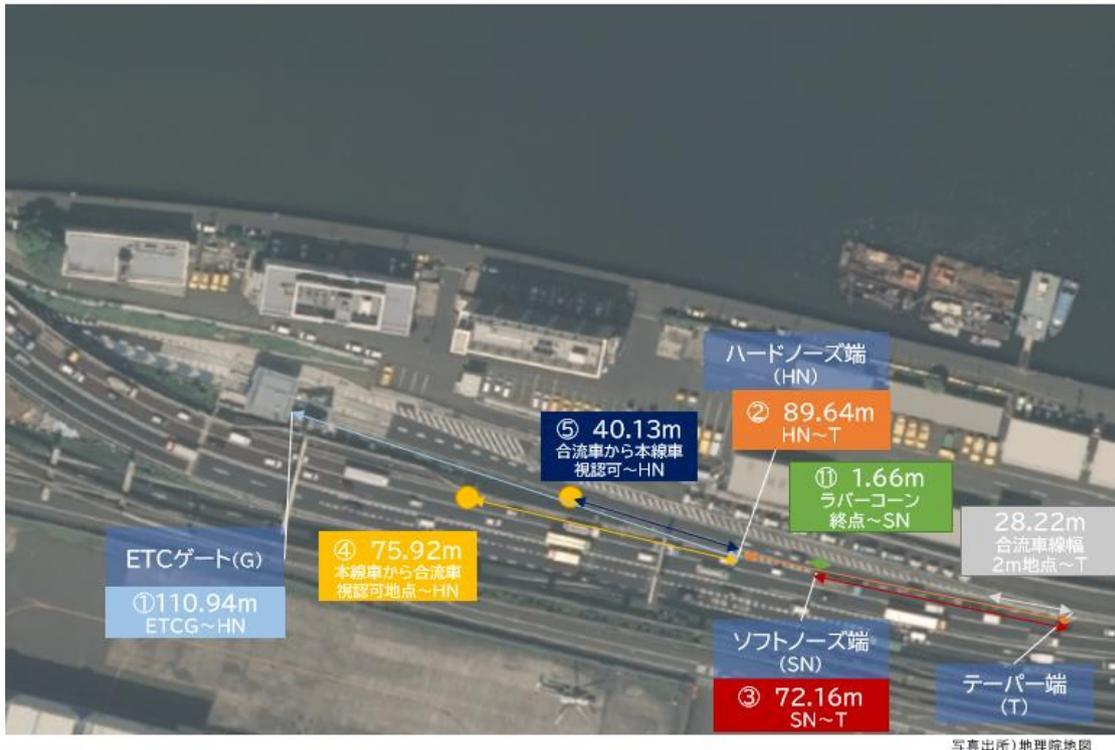
図 5-3 合流部道路線形調査 – 計測項目を航空写真上に示した例
