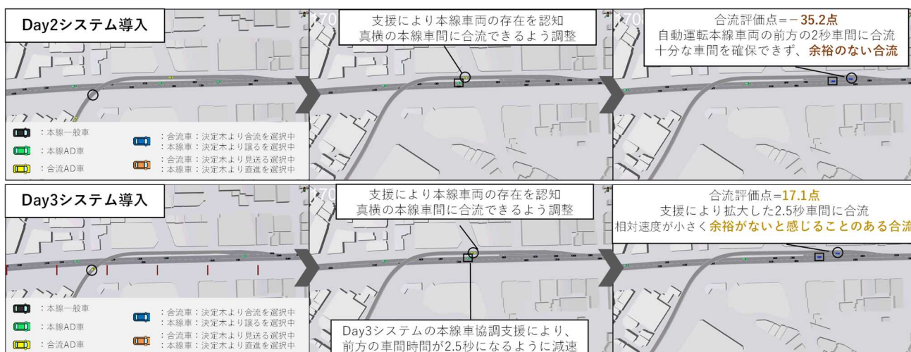
図 7-5 Day2 システムから Day3 システムへの変更に伴い余裕のない合流が解消した例
