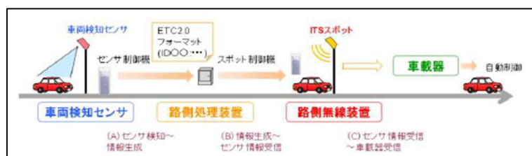
図 5-10 センサ検知から車載器受信までの流れ（出典 [1] p43）
