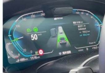
しかも隣の車線まで、また前車線に追従するのでADながらも交通の「流れ」にキチンと乗るあたりはドライバーの感覚に近い。車線変更時にはウィンカー操作に応じて車線変更してくれるステアリング&レコンコントロールも便利と思う。
