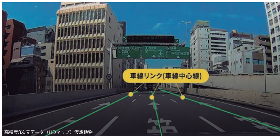
高精度3次元点群データをもとに、区画線(白線や破線など)や路肩線、さらに道路標識など、リアルワールドの実在地物と、車線リンク(車線中央線)のように実在しない仮想地物のデータを加え、高精度3次元地図データが完成
