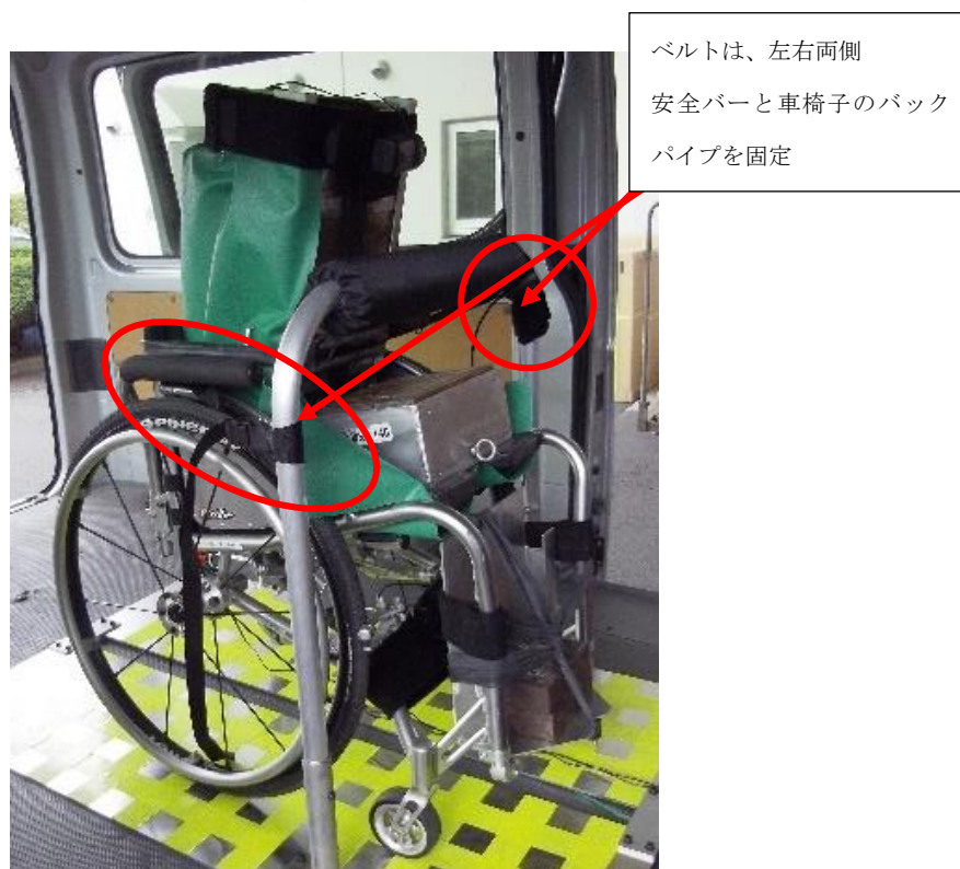
図表 3-34 アクティブ車椅子のベルト固定の検証
