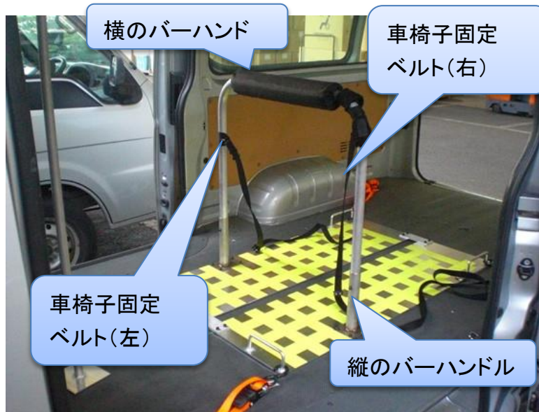
図表 3-5 ジェットコースター型安全バーの試作
