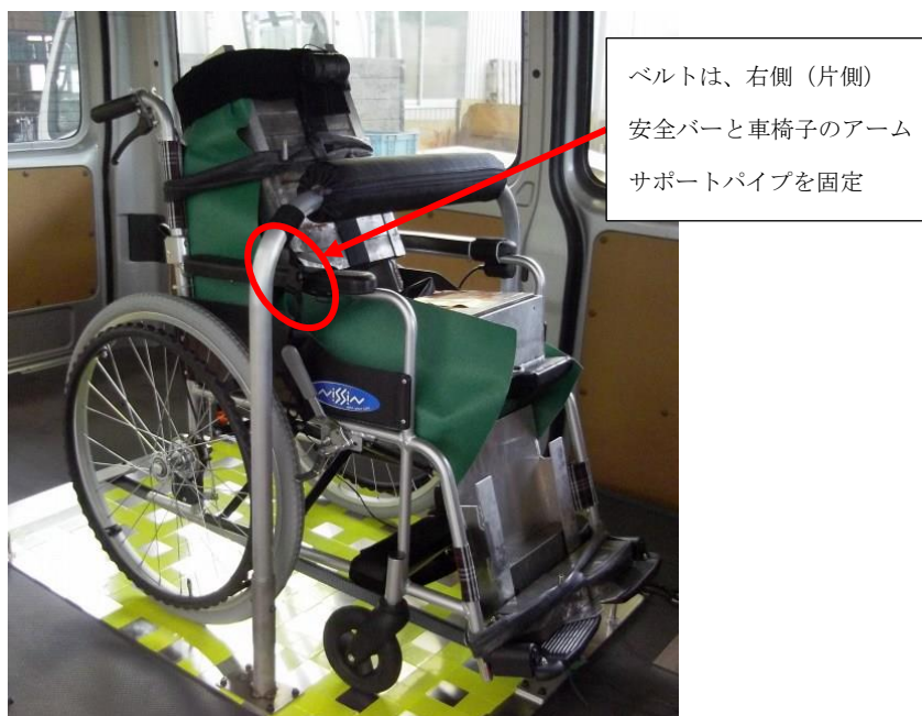
図表 3-33 JIS 標準型車椅子のベルト固定の検証図
