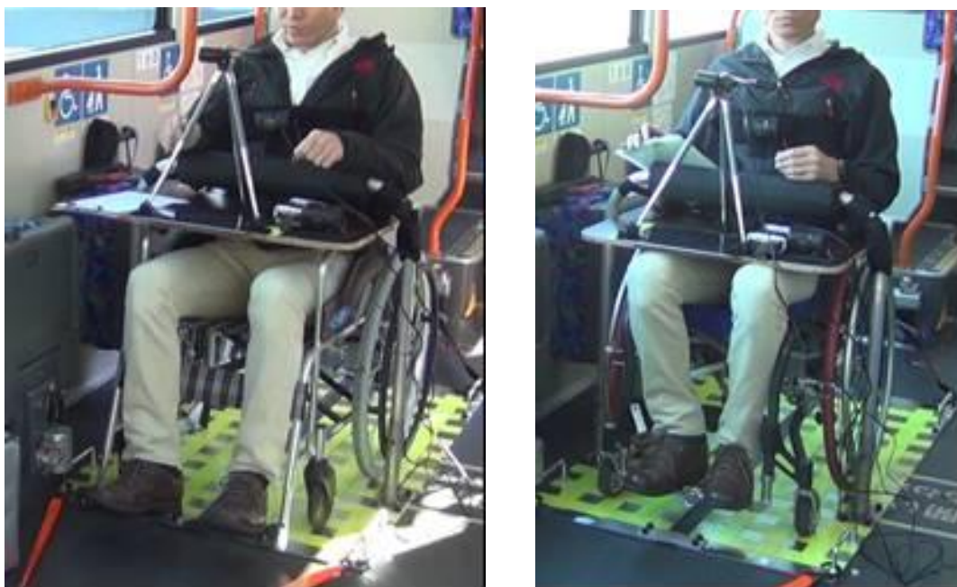
図表 3-47 実験車両へのジェットコースター型安全バーと車椅子固定状況
