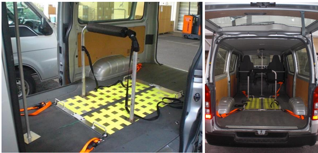
図表 3-15 実験車両へのジェットコースター型安全バー固定状況
