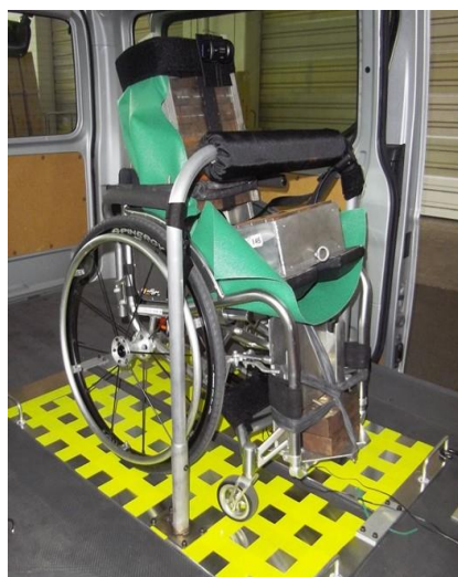
図表 3-14 アクティブ車椅子の装置固定
