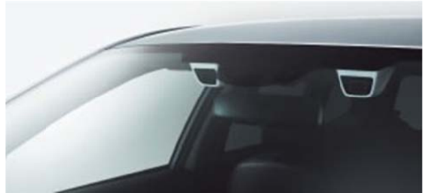
図3.5.1.2-ウ-3 スバル「アイサイト」ステレオカメラ（出典：スバルHP）
