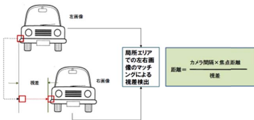
図3.5.1.2-ウ-1 ステレオビジョン距離検出原理
