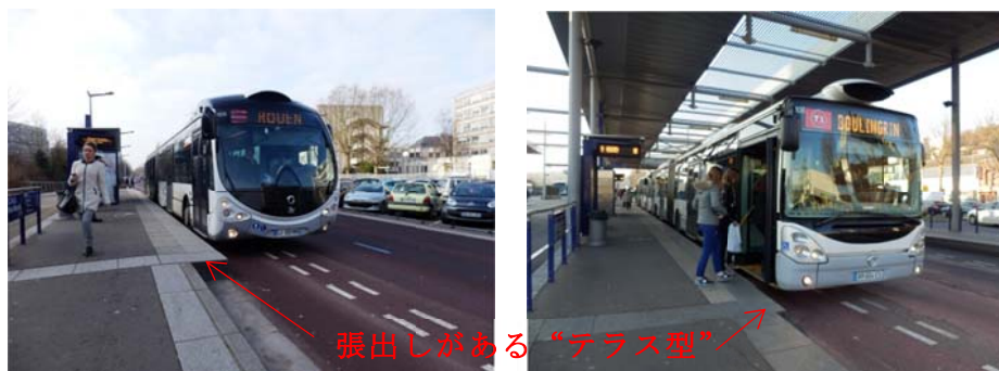
図3.2.6-6 電車の駅の様に直線で長いテラス型プラットフォーム
