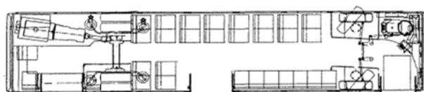
図3.2.8-（1）-6 欧米低床バスの動力系設計と搭載設計
