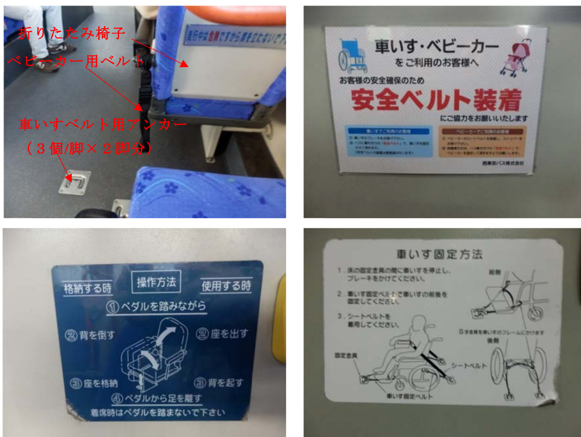
図3.2.7-3 現行ノンステップバスの優先席の車いす固定スペースとコーションプレート
