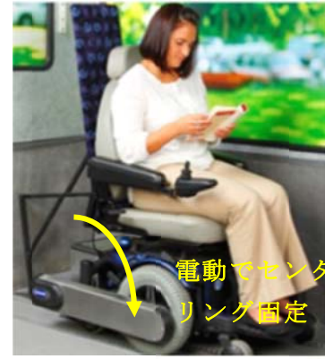
床面へのアンカーレール (固定位置自在)
