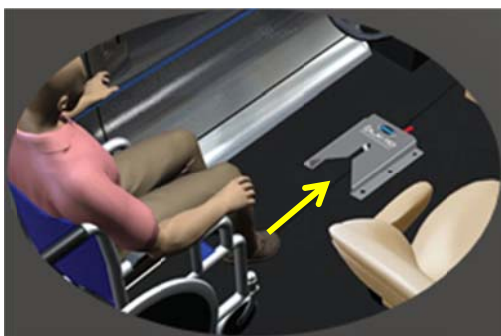
床面へのアンカーレール (固定位置自在)
