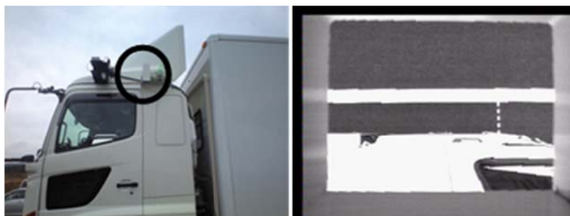
図3.5.2.1-2 エネルギーITSにおけるカメラおよび白線画像
