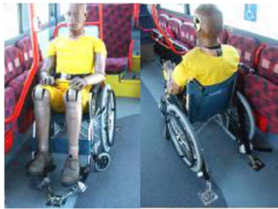
図5.6 前向き3点ベルト式固定装置の例
