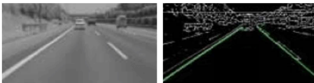
図3.5.2.1-1 カメラ画像と白線認識処理画像
