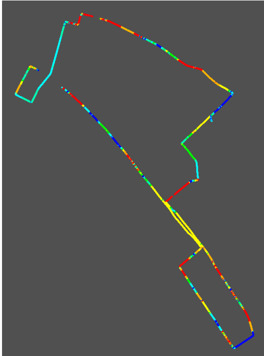
図 5.63 左右方向誤差 MAP 都心一般道／1 回目 GPS+QZSS+GLONASS (単独測位解+PPP 解)
