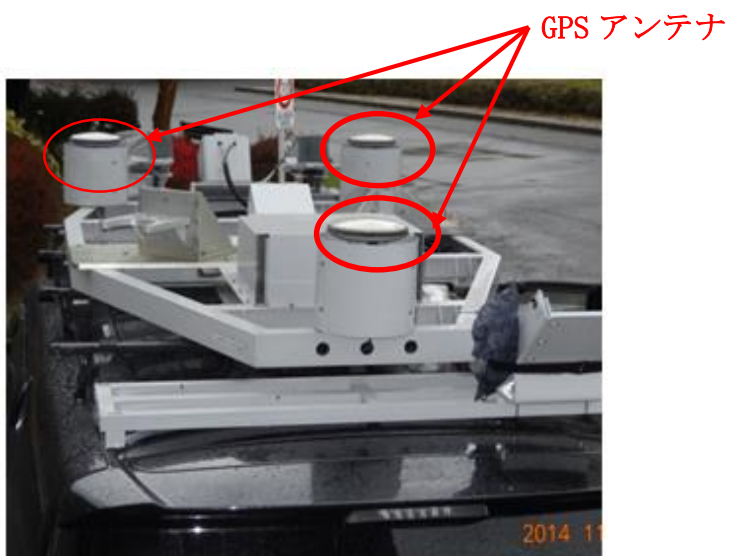
図 2.10 MMS 天井部のアンテナ
