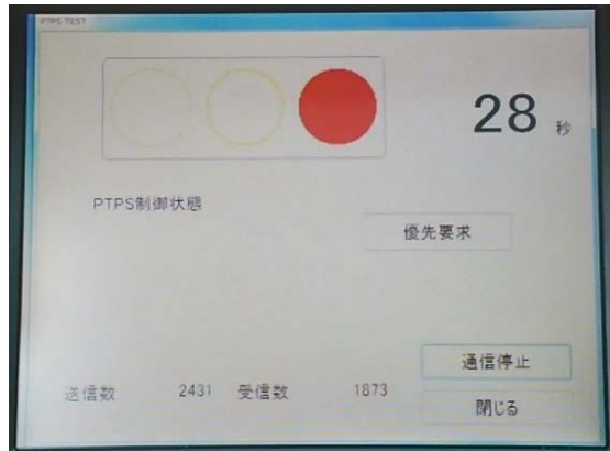
図 3.4-7 車内ディスプレイの表示例(PTPS リクエストなし)
